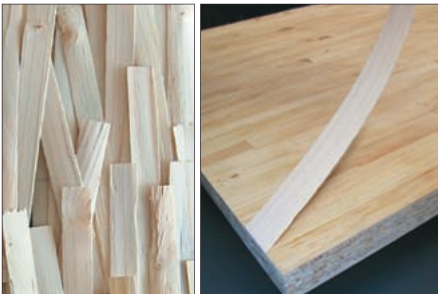
Рис. 1.4. Альтернатива клеёной фанере: форматированная крупномерная стружка идёт на изготовление листового материала, бруса, а также на создание упрочнённого верхнего слоя ДСтП или OSB (иллюстрация предоставлена фирмой SAB)
