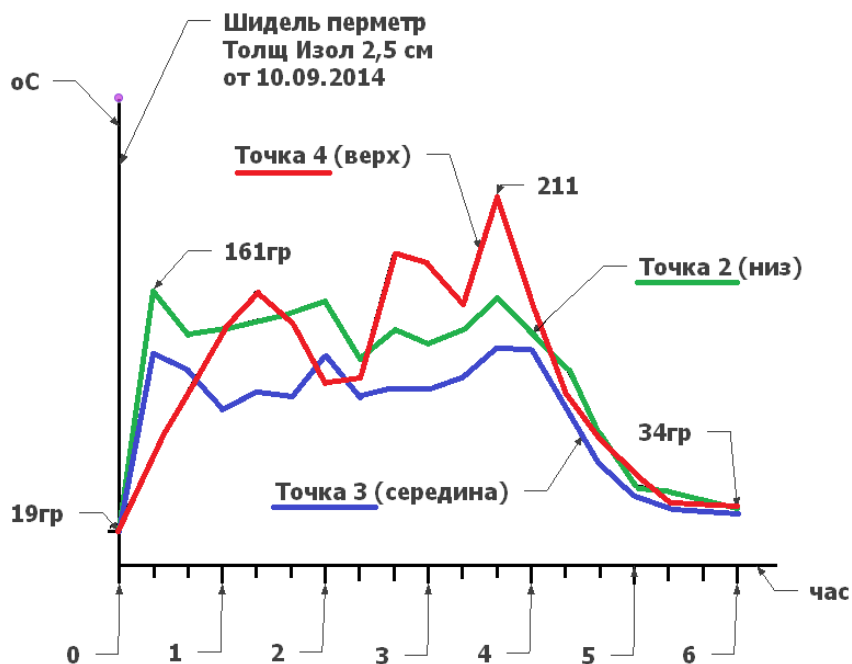
Рис.17. Графики изменения температуры наружных поверхностей трубы Permeter (Германия) с толщиной изоляции 25мм.
