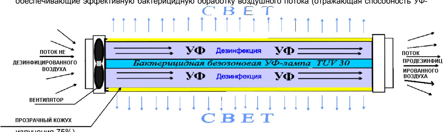
5.3. Устройство рециркулятора CH111-115, CH111-130
