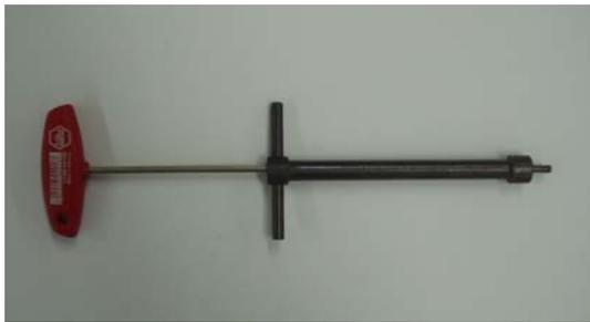
**Назначение:** Приспособление, которое используется для замены пластинчатого теплообменника.
