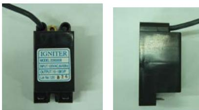
**Предназначение:** используется для преобразования напряжения в системе розжига горелки.
