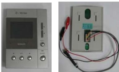
**Предназначение:** используется для диагностики неисправностей, считывания параметров работы компонентов котла, изменения настроек электронного блока управления (основного),
