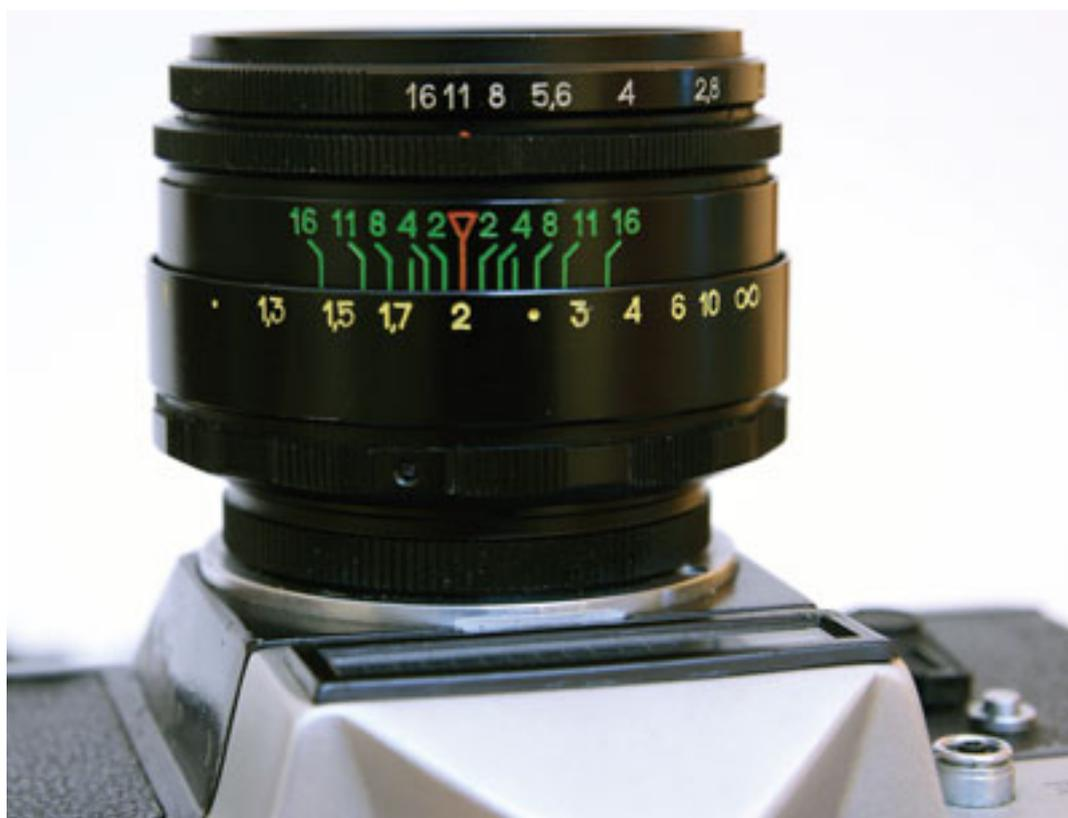
Рис. 5.6. Объектив Гелиос-44-2, установлена диафрагма f11. Шкала диафрагмы – верхняя, с белыми цифрами. Как видно по шкале глубины резкости (зеленая – средняя), при установке расстояния 2 м (желтая шкала расстояния – нижняя) в пределах от 1,6 до 2,9 м на снимке все объекты будут резкими. Это видно по интервалу, отмеренному цифрами 11 зеленой шкалы.
