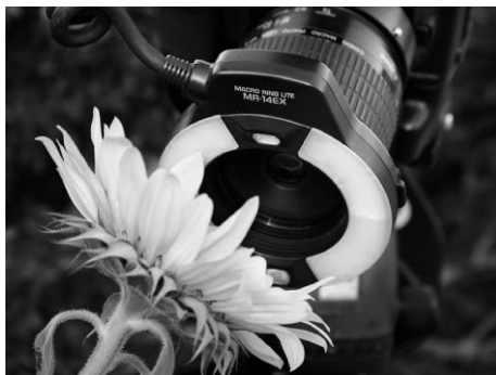
Рис. 3.18. Кольцевая вспышка Canon MR-14EX Macro Ring Lite специально предназначена для макросъемки. В ней применяются пара соединенных кольцом ламп-вспышек, которые могут запускаться как совместно, так и раздельно (см. также цветную вклейку)
