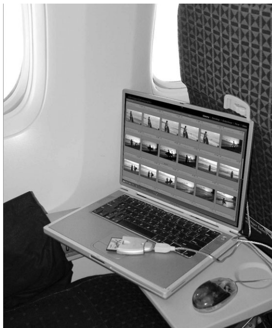
Рис. 3.3. Устройства считывания с карт памяти представляет собой очень важную принадлежность, позволяющую загружать изображения в компьютер, освобождая от этой функции фотокамеру. При этом экономится также ценная энергия заряда батареи фотокамеры. Подключив такое устройство к портативному компьютеру, можно заняться обработкой полученных изображений даже во время полета на высоте 10 тыс. м
