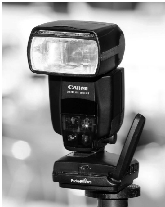
Рис. 3.16. Радиосинхронизатор фирмы Pocket Wizard ( www.pocketwizard.ru ), установленный на вспышке Canon 580EX II Speedlite
