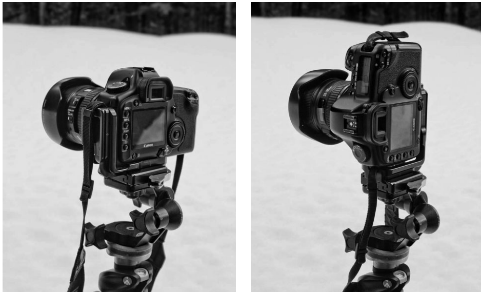
Рис. 3.10. Угловая установочная площадка фирмы Really Right Stuff ( www.really-rightstuff.com ) сконструирована под шаровую штативную головку фирмы Arca-Swiss и под другие корпуса цифровых фотокамер, хотя имеются специальные адаптеры под другие типы штативных головок. Благодаря этому данная площадка идеально прилегает к основанию фотокамеры. Такая конструкция сдвоенных быстр съемных пластин позволяет быстро переходить от горизонтальной к вертикальной ориентации фотокамеры, не меняя положения штативной головки
