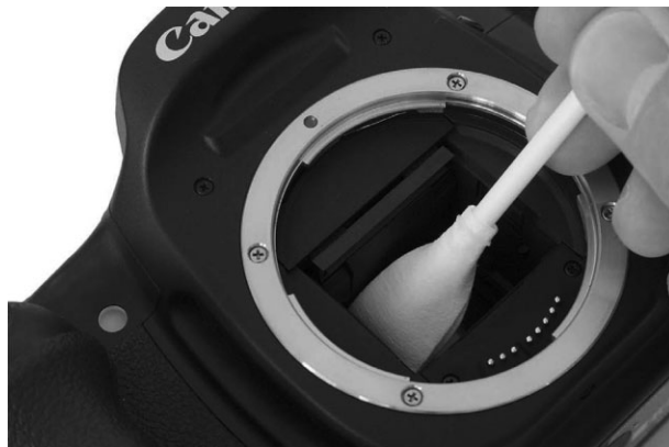
Рис. 3.45. Чистка датчика изображения цифровой зеркальной фотокамеры помазком type Sensor Swab фирмы Photographic Solutions
