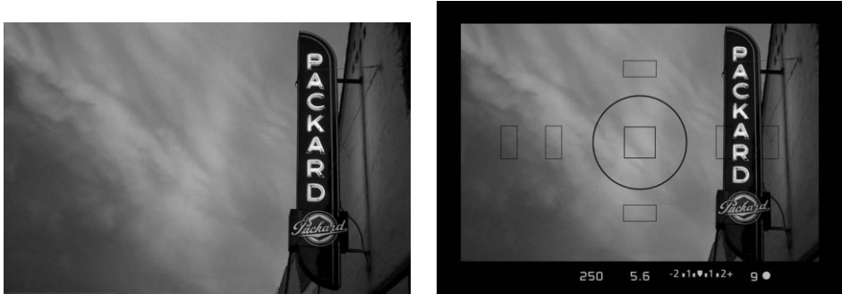
Рис. 2.21. В оптический видоискатель цифровой зеркальной фотокамеры видна та же самая сцена и при тех же условиях освещения, что и в объектив во время съемки
