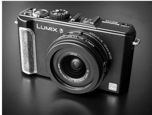
Рис. 2.6. Цифровые компактные фотокамеры имеют несменные объективы, хотя для получения эффекта широкоугольного объектива или телеобъектива могут применяться дополнительные насадочные линзы. (Светлая полоска была специально наклеена фотографом на гладкий корпус этой фотокамеры, чтобы сделать его поверхность шероховатой и обеспечить более надежный захват.)
