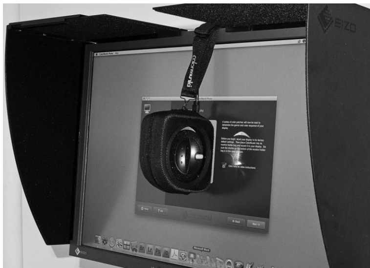
Рис. 9.4. Датчик, устанавливаемый на экране монитора, считывает конкретные значения цвета, воспроизводимые профилируемым монитором на этапе его калибровки, обеспечивая формирование как можно более точного профиля
