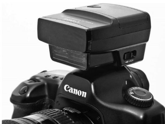
Рис. 3.15. ИК-схронизатор, устанавливаемый на фотокамере, позволяет управлять вспышкой, находящейся вне фотокамеры, значительно расширяя возможности освещения снимаемой сцены. С помощью ИК-схронизатора можно управлять несколькими вспышками, регулируя их мощность
