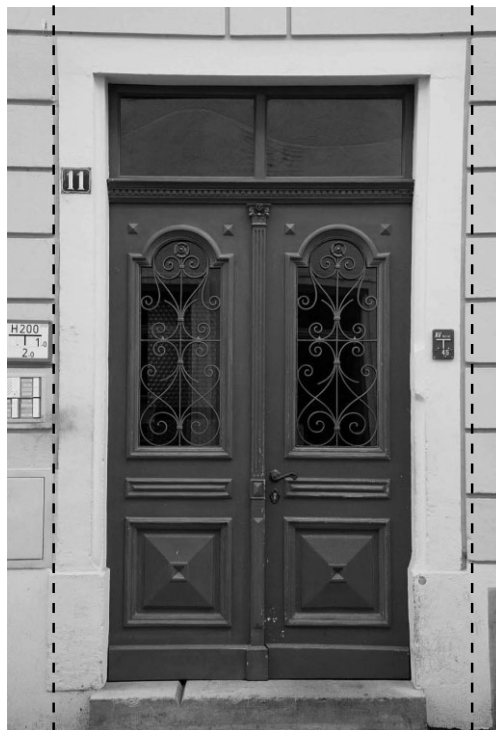
Рис. 2.14. Подушкообразное искажение наиболее заметно на прямых линиях вблизи краев изображения, где они изгибаются внутрь (см. для сравнения черные пунктирные линии, специально наложенные на изображение по обеим его сторонам)
