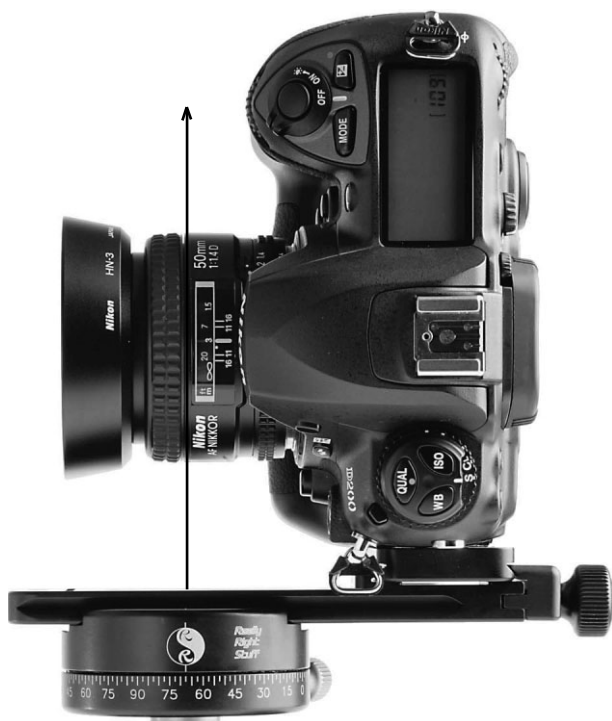
Рис. 6.10. Узловой направляющая, например, компании Really Right Stuff , представленная на этом рисунке, позволяет выровнять оптический центр объектива по центральной точке вращения штатива. Печатается с любезного разрешения компании Really Right Stuff
