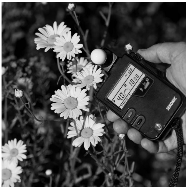
Рис. 5.4. Ручной экспонометр с колпачком для измерений в падающем свете, т.е. для измерения света, падающего на объект съемки
