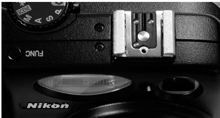
Рис. 2.47. Специальная обойма на верхней стороне корпуса цифровой фотокамеры дает возможность использовать самые разные виды внешних вспышек с максимальным удобством
