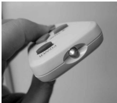
Рис. 3.41. Чувствительность фотокамеры к инфракрасному свету можно проверить с помощью снимка пульта дистанционного управления, направленного на фотокамеру при нажатой на нем кнопке
