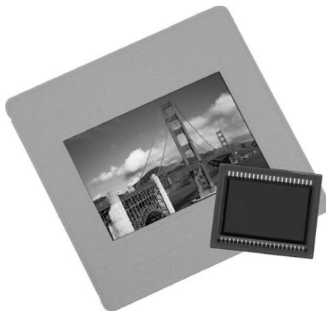
Рис. 2.5. Титчный датчик изображения заметно меньше кадра 35-миллиметровой пленки
