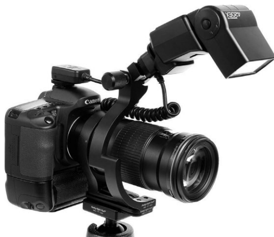
Рис. 3.17. На этом снимке показана цифровая зеркальная фотокамера Canon со специальным кронштейном для вспышки B85 фирмы Really Right Stuff. Модель B85 сконструирована для присоединения к хомутообразному штативному креплению на телеобъективе. Это дает дополнительные удобства для съемки телеобъективом и со вспышкой. Установочная пластина может быть наклонена вниз для организации более направленного освещения. Благодаря этому такая конструкция идеально подходит для макросъемки
