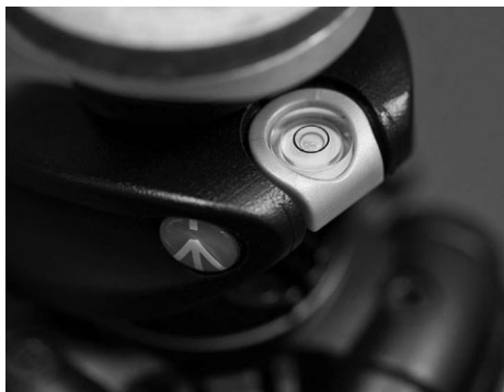
Рис. 6.8. Пузырьковый уровень в основании головки штатива служит важным средством для установки штатива в ровном положении
