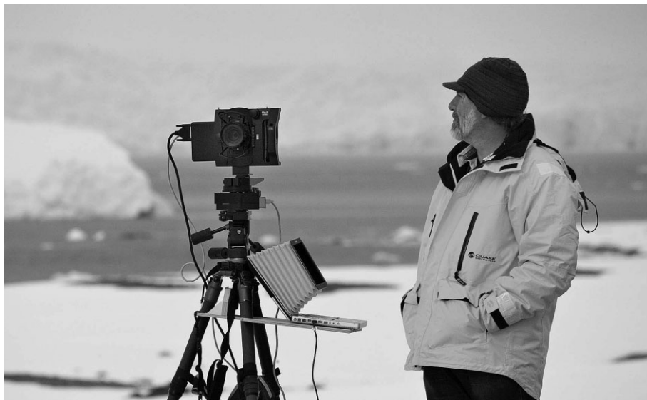
Рис. 2.54. Модель Better Light сканирующей фотоприставки формата 4×5 является цифровым аналогом крупноформатного павильонного фотоаппарата. На этом снимке запечатлен пейзажный фотограф Стивен Джонсон, снимающий сцену в Антарктике (обратите внимание на переносной компьютер с кожухом для монитора, присоединенный к фотоприставке и установленный на специальной платформе, крепящейся на штативе). Фото Джеффа Шьюи
