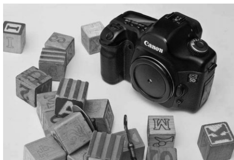
Рис. 3.33. Фотографирование цифровой камерой-обскурой — это своеобразное сочетание нового и старого. Подобным способом можно снимать объекты, очень близко расположенные к фотокамере. Справа на этом рисунке приведен натюрморт, снятый цифровой зеркальной фотокамерой Canon 5D с отверстием под точечную диафрагму в крышке для ее корпуса, показанной слева. Полученное в итоге изображение экспонировалось 6 секунд при показателе светочувствительности 800 ISO
