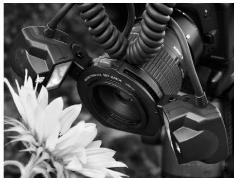
Рис. 3.19. Компания Canon выпускает две небольшие головки вспышек модели MT-24EX Macro Twin Lite для тех фотографов, которым требуется максимальный контроль над освещением во время макросъемки. Обе головки присоединяются на конце объектива независимо друг от друга и допускают раздельную регулировку уровня выходной мощности (см. также цветную вклейку)
