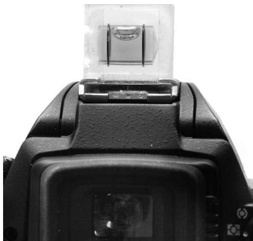
Рис. 3.50. Небольшой пузырьковый уровень, специально сконструированный для установки в обьему фотокамеры, помогает правильно установить штатив с фотокамерой по уровню
