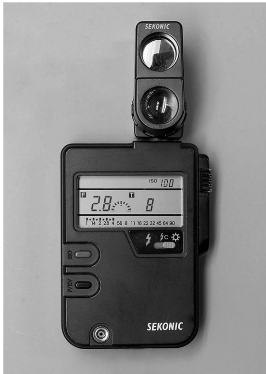
Рис. 5.3. Ручной экспонометр с оптической насадкой для точечных измерений в пределах поля зрения 5°
