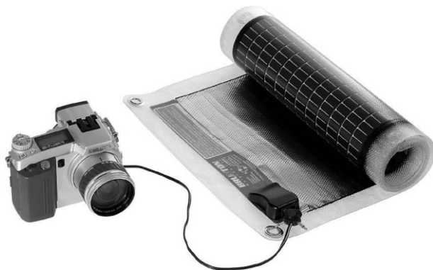
Рис. 3.2. Зарядное устройство на солнечных батареях SolarRoll 14, выпускаемое компанией Brunton ( www.brunton.com ), представляет собой водонепроницаемую панель на солнечных элементах из аморфного полупроводника с выходной мощностью 14 Вт при напряжении 15,4 В. Такую панель можно скатывать в рулон, укладывать в тубус и очень удобно носить вместе с фоторюкзак. Фото воспроизводится с любезного разрешения компании Brunton
