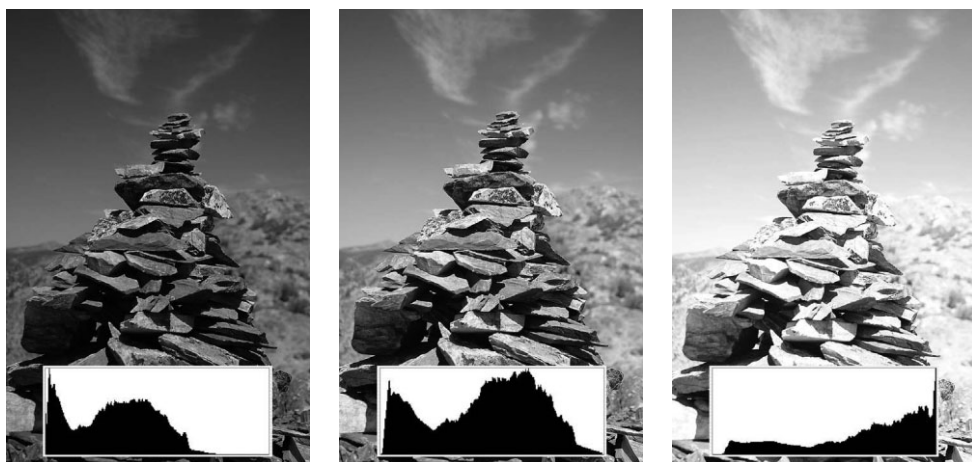
Рис. 5.23. Умение правильно интерпретировать гистограмму, отображаемую в фотокамере, имеет большое значение для фиксации изображений с правильно выбранной экспозицией. Слева направо приведены три снимка пирамиды из камней. Первый из них сделан с недодержкой и потерей деталей в области теней, второй — с нормальной экспозицией и заполнением всей градационной шкалы, третий — с передержкой и погашенными светами
