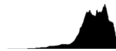
Рис. 5.26. Гистограмма снимка, экспонированного со сдвигом вправо для использования самого важного участка градационной шкалы
