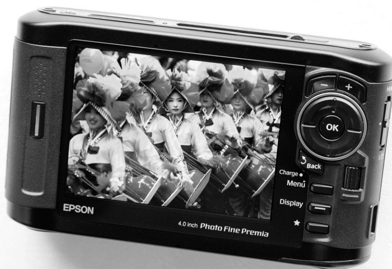
Рис. 3.4. Мультимедийное просмотрное устройство Epson P-7000 Multimedia Photo обладает емкостью 160 Гбайт и имеет 4-дюймовый цветной экран для просмотра изображений. Для загрузки изображений карты памяти можно вставлять непосредственно в это просмотрное устройство. Фото Джека Резницки
