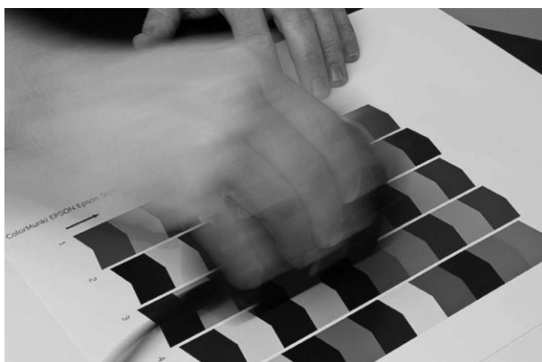
Рис. 9.5. Построение собственных профилей принтеров специальными инструментальными средствами дает возможность относительно просто делать точные отпечатки на самых разных печатающих устройствах и различных сортах бумаги
