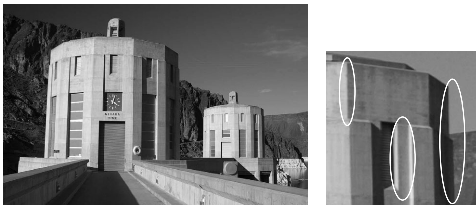
Рис. 2.16. Хроматическая аберрация чаще всего возникает на высококонтрастных краях снимка, как показано на рисунке справа
