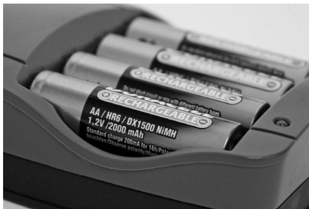
Рис. 3.1. Если ваша компактная фотокамера питается от батарей формата AA, то применяя никель-металлогидридные аккумуляторные батареи, вы сэкономите не мало средств в долгосрочной перспективе
