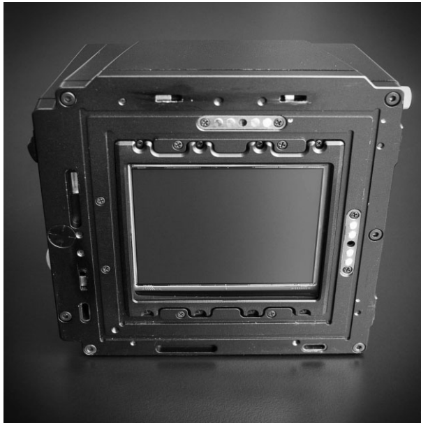
Рис. 2.53. Цифровые фотоприставки присоединяются сзади к обычным пленочным фотокамерам среднего формата, что дает возможность получать цифровые изображения с помощью фотоаппаратуры, предназначенной для пленочной фотографии
