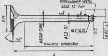
Рис. 36. Клапаны увеличенного размера: а — впускной клапан М-412 из клапана ГАЗ-24; б — выпускной клапан М-412 из клапана ГАЗ-24; в — впуск- ной клапан ВАЗ из клапана ЭСО; г — выпускной кла- пан ВАЗ из клапана ЭСО
