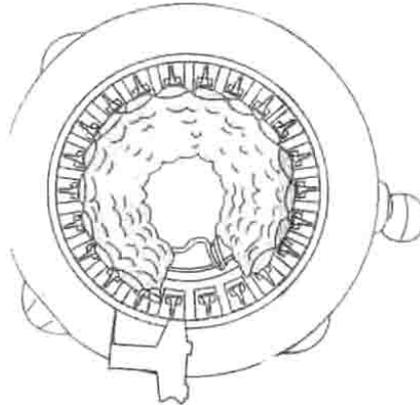
Переведите переключатель в положение вязания полотна. Поворачивая ручку, проденьте нитку через нитедержатель. Возможно поворачивать ручку в обоих направлениях.
