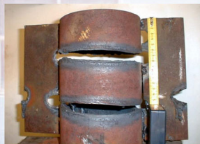
Результат лазерной резки стальной трубы (толщина стенки 20мм, расстояние 50м)
