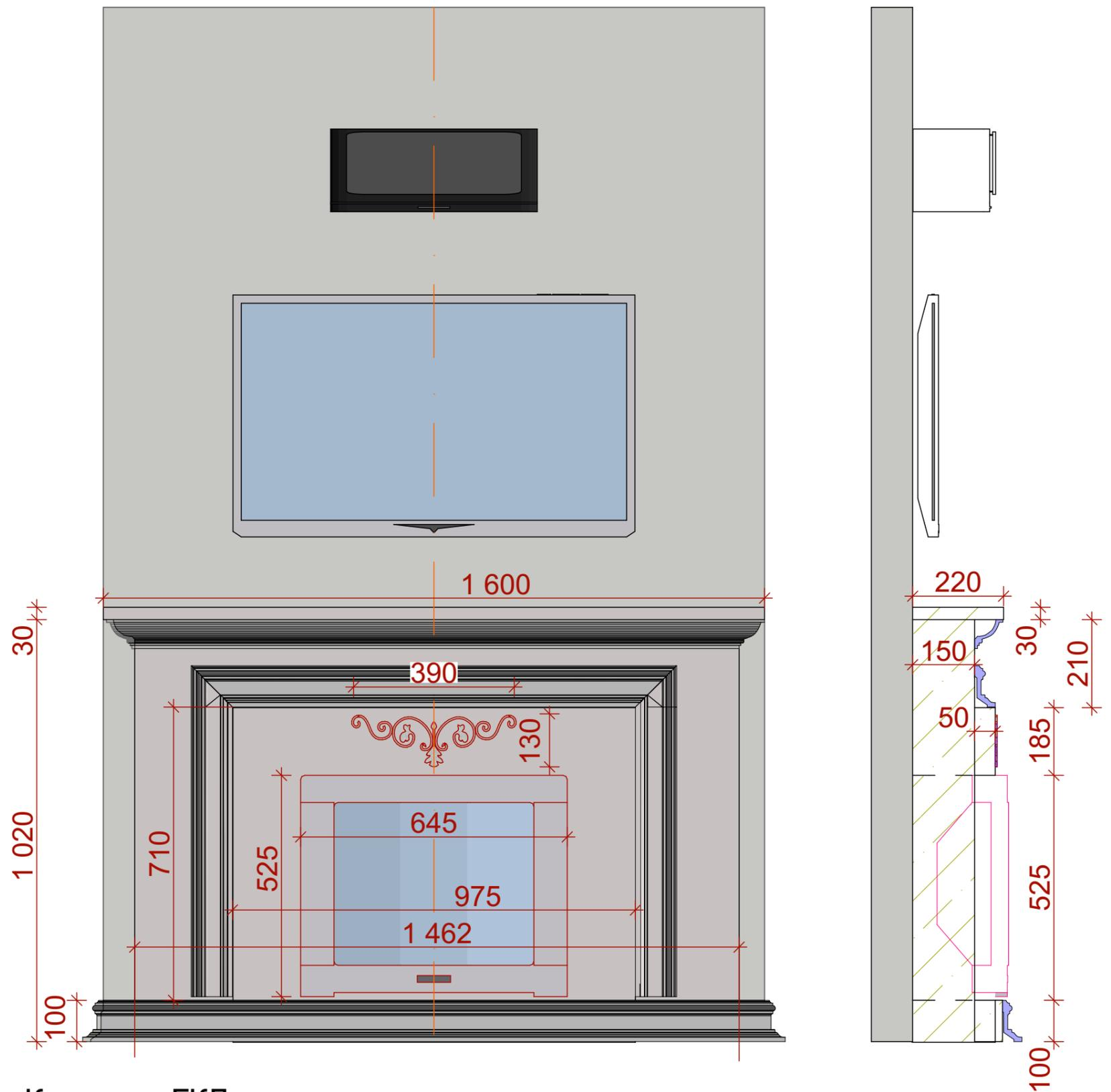
Камин из ГКЛ-конструкции с пенополиуретановыми молдингами. Молдинги и эл. топка в наличии. Нужно сделать ГКЛ-конструкцию, приклеить молдинги и всё покрасить. Столешница, скорее всего, из ЛДСП. Все материалы предоставит заказчик. Интересует стоимость твоей работы.
