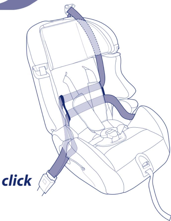
Пропустить брюшную и диагональную секцию ремня автомобиля через канал прохождения направляющая-ремень в подлокотнике на стороне, близкой к застежке ремня автомобиля.
