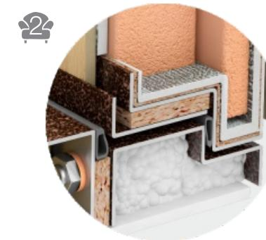
**Два контура уплотнителя:**
