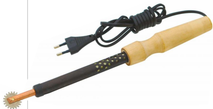
4. ЭПСН – П 10Вт/220В электропаяльник мощностью 10Вт напряжением 220В и для наващивания рамок.
