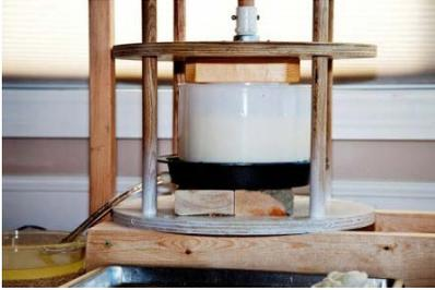
Гауда находится под прессом 16 часов. Трехлитровая банка сверху - дополнительные 3 фунта, которые нужны были для окончательного прессования.
