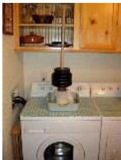
Джо использовал укороченный сосновый поршень, чтобы вставить толкатель и поддержать вес. Верхняя часть дубеля привязана к подвешенной вниз марле на резинке!
