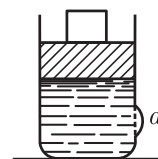
Рис. 218. Резиновая пленка a , затягивающая отверстие в стенке сосуда, заметно выгнута силами давления воды
