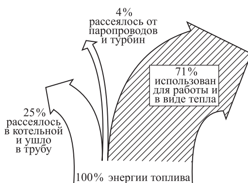
Рис. 520. Примерный энергетический баланс ТЭЦ
