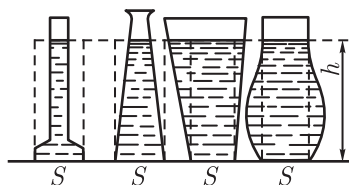
Рис. 249. Во всех изображенных сосудах сила давления на дно одинакова. В первых двух сосудах она больше веса налитой жидкости, в двух других — меньше
