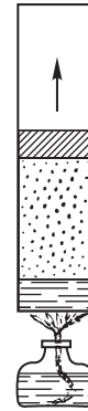
Рис. 492. Образующиеся пары поднимают поршень. При этом производится работа против сил внешнего давления
