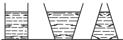
Рис. 252. Силы, действующие на жидкость со стороны стенок в сосудах различной формы
