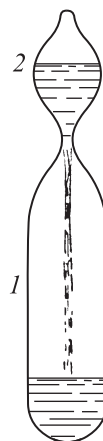
Рис. 479. В сосудах 1 и 2 находятся вода и ее пар, воздух отсутствует; вода из сосуда 2 полностью стекает в сосуд 1
