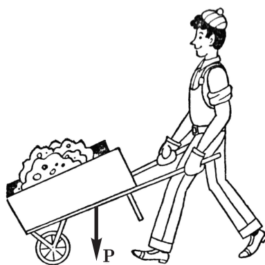
Рис. 139. Тачка как рычаг
