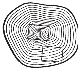
Рис. 443. Строение дерева вблизи сердцевины и вблизи края различно
