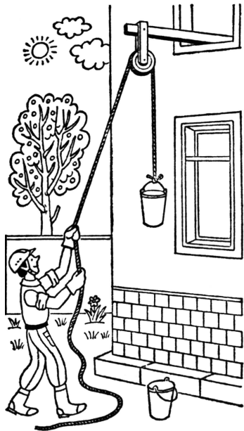
Рис. 141. Применение простого блока для подъема груза
