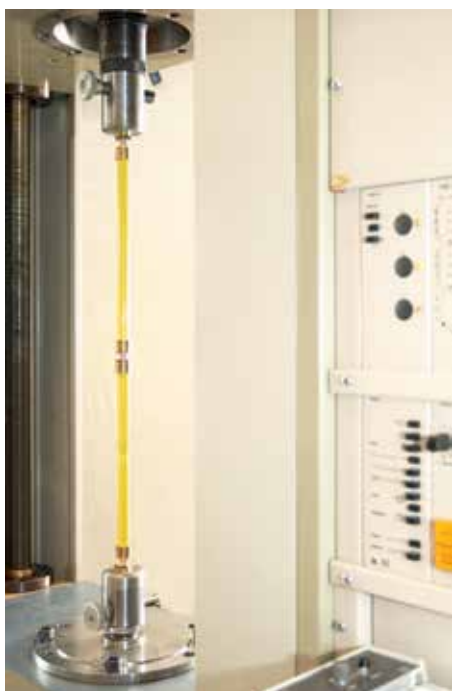
Многослойная труба TECEflex: испытание на растяжение
