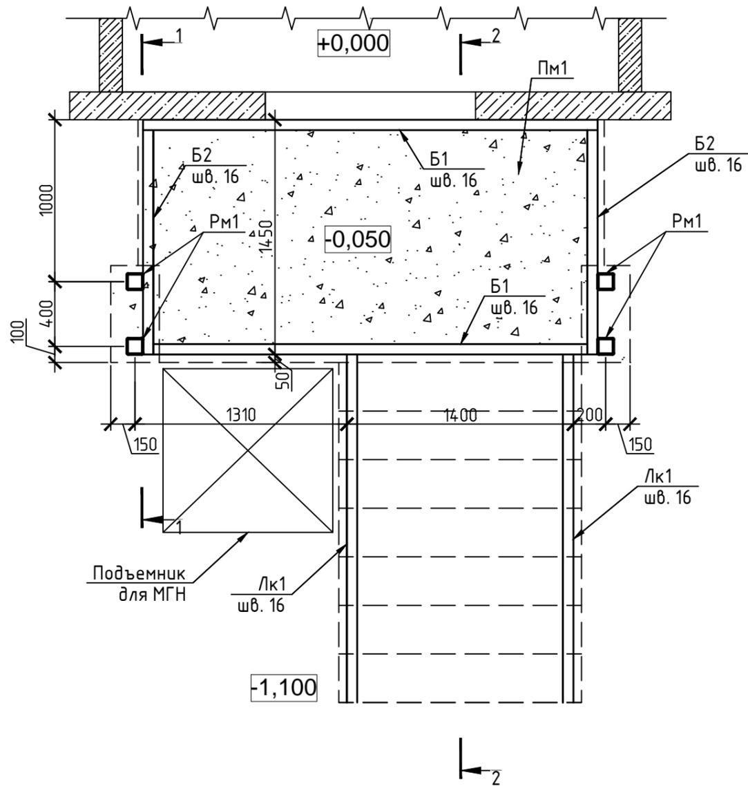
Схема конструкций навеса крыльца
