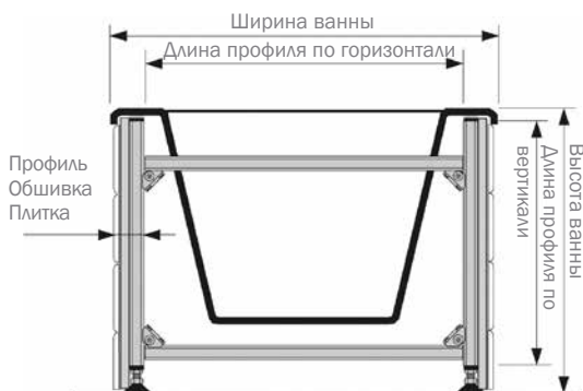
Точный расчет длины / ширины конструкции для свободстоящих ванн
