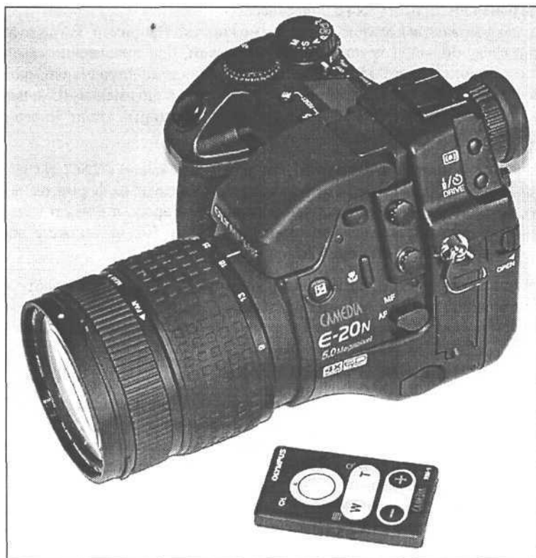
Рис. 3.8. Эта модель компании Olympus позволяет делать снимки, не нажимая пальцем кнопку "Спуск затвора"
