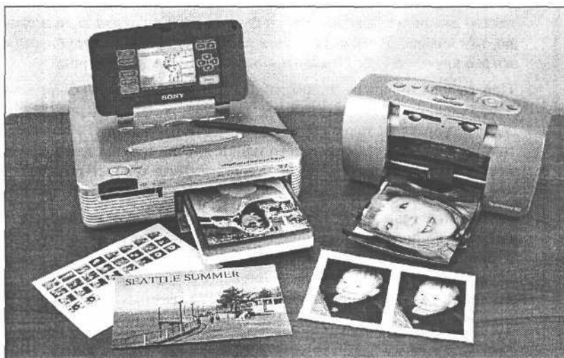
Рис. 8.3. Принтеры, подобные представленным здесь моделям компаний Sony (слева) и Hewlett-Packard (справа), могут создавать распечатки небольшого размера, используя информацию непосредственно с карт памяти
