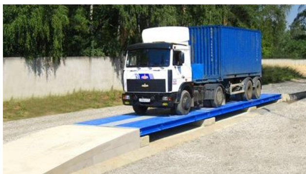
Рис. 1.2. Стационарные автомобильные весы до 100 т измеряемой массы
