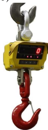
Рис. 1.7. Встроенные весы: а – монорельсовые; б – крановые
