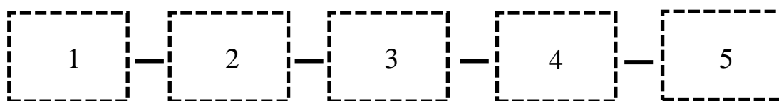
Рис. 4.5. Схема условного обозначения ТР (ГОСТ 21616-91)
