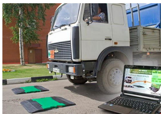
Рис. 1.3. Передвижные автомобильные весы на 20 т
