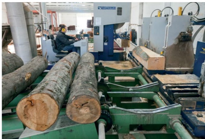
Распиловка бревен на производительной итальянской пилораме.
