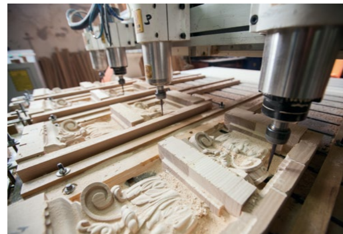
При производстве резбовых элементов применяются фрезерные многошпиндельные ЧПУ станки.
