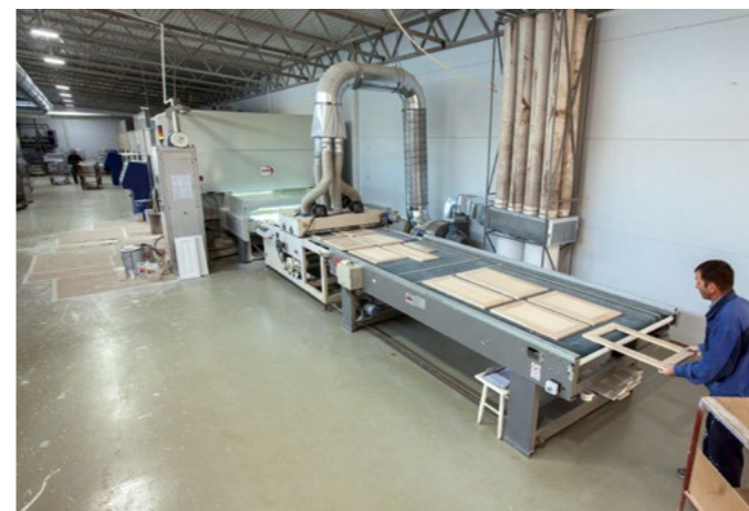
Отделочные материалы наносятся на автоматизированных итальянских покрасочных линиях.
