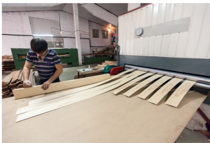
Строгание и сушка шпона на японском оборудовании.
