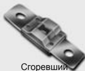
Сгоревший предохранитель 1VQA4037
