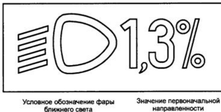
Рисунок Ж. 1 - Пример условного обозначения фары
