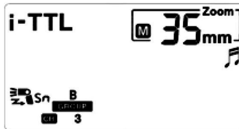
S1 и S2 предназначены дистанционного запуска вспышки YN568EX через встроенную светоловушку от импульса любой другой вспышки. В этих режимах мощность управляется только вручную (M) от 1/128 до 1/1 мощности с шагом 1/3 ступени кнопками [ВЛЕВО] / [ВПРАВО]. При помощи кнопок на джойстике [ВВЕРХ] / [ВНИЗ] производится тонкая настройка мощности м промежуточными значениями 0.3, 0.5 и 0.7 ступеней
