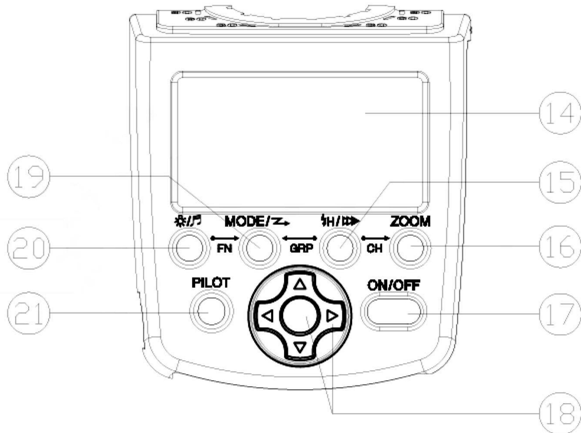
14. **LCD дисплей:** отображение статусов выбранных функций.
