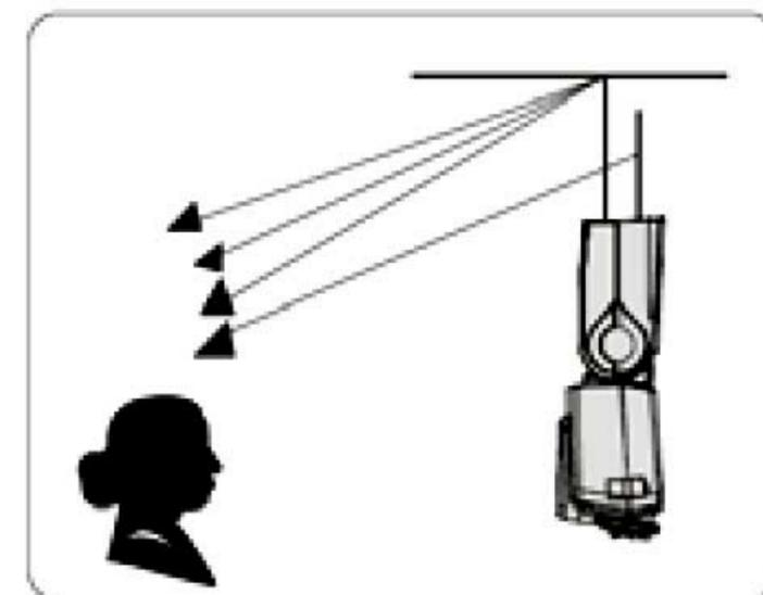
Потяните вверх широкоугольную панель и белую панель, вместе. Затем, задвиньте назад широкоугольную панель.
