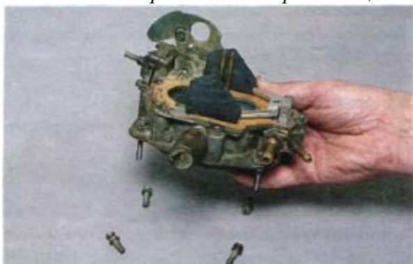
...крышку переворачиваем поплавками вверх над столом или крышкой корпуса воздушного фильтра.
