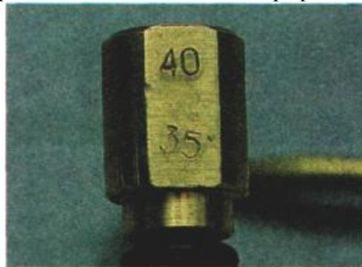
Пример маркировки распылителя: нижняя цифра, выбитая на корпусе, — диаметр выходного отверстия распылительной трубки первой камеры в сотых долях миллиметра, верхняя — второй камеры
