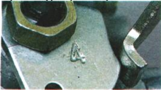
Пример маркировки привода кулачка привода ускорительного насоса.
