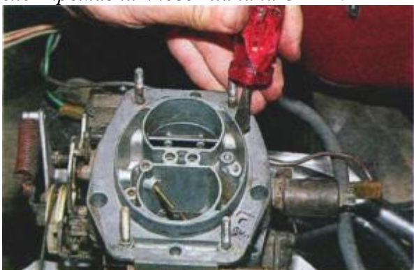
Отверткой отворачиваем пять винтов крепления крышки карбюратора.
