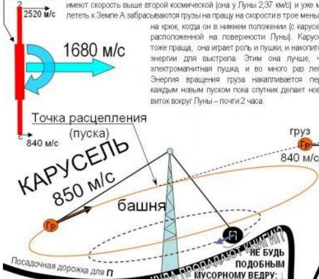
Чтобы башня не сломалась в вог, есть противовес раз в 10 массивнее груза, тогда ему достанется лишь 1/10 кинетической энергии, накопленной от солнечной электростанции. Противовес и груз сбрасываются одновременно, чтобы не упала башня. Вся система раскручивается электромотором, уст. под башней. Этот же мотор в режиме генератора перед новым зарядом системы рекуперирует оставшуюся энергию вращения массивных канатов.
