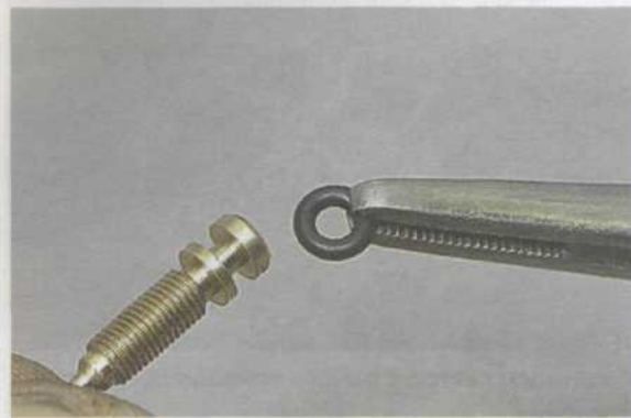
Снимаем с иглы резиновое уплотнительное кольцо.
