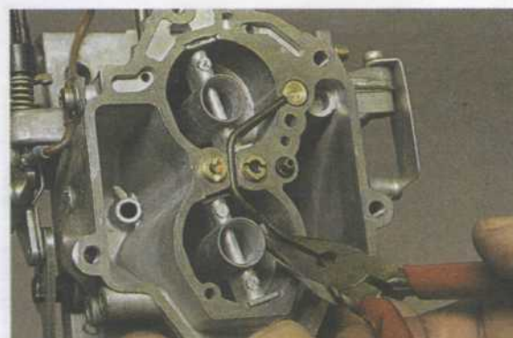
...плоскогубцами с тонкими губками подгибаем распылительные трубки, добиваясь оптимального направления струй.
