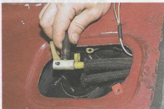
Насосом продуваем топливопроводы в направлении от бака.
