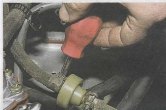
Отверткой ослабляем затяжку хомутов крепления клапана.
