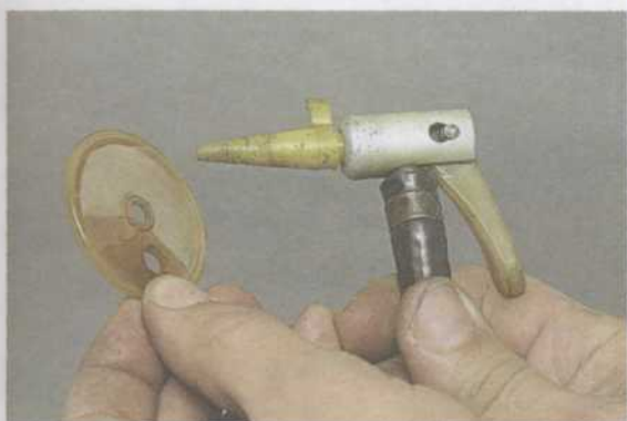
Промываем фильтр в чистом бензине и продуваем сжатым воздухом.
