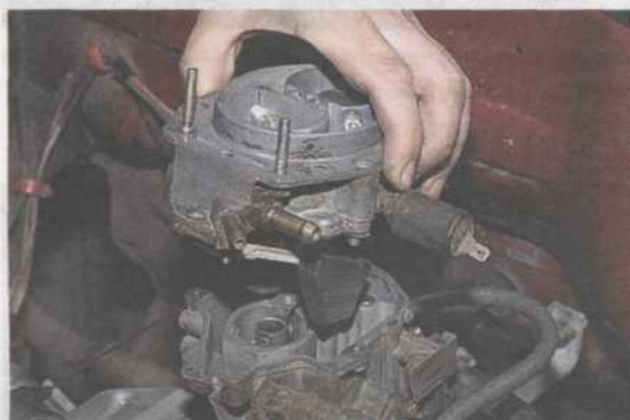
Аккуратно, не повредив поплавки и прокладку, снимаем крышку.
