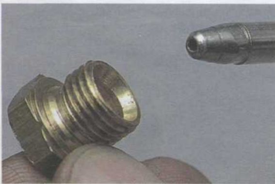
...и внутреннюю полость пробки фильтра.
