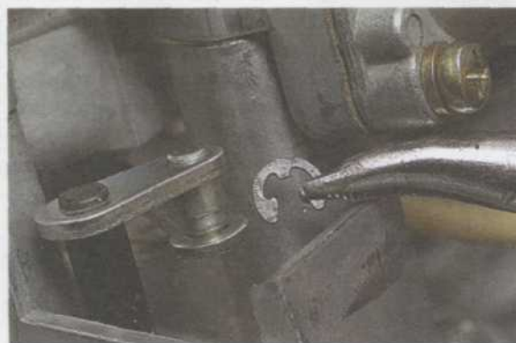
Снимаем стопорную шайбу тяги привода воздушной заслонки.
