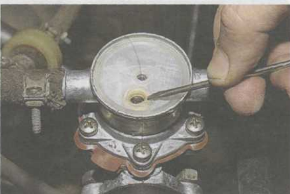
...продуваем сжатым воздухом внутреннюю полость насоса.
