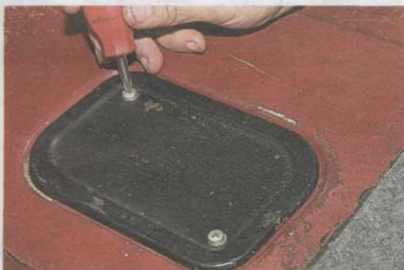
Отворачиваем два самореза крепления...
