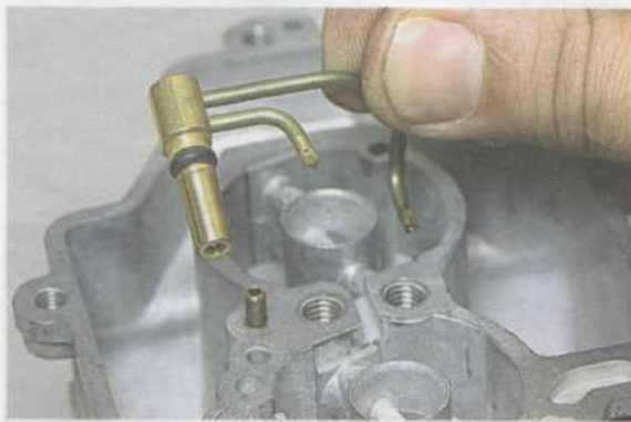
...вынимаем распылитель ускорительного насоса.
