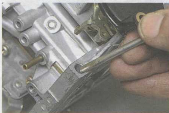
Отверткой с лезвием шириной 4 мм отворачиваем винт «качества».
