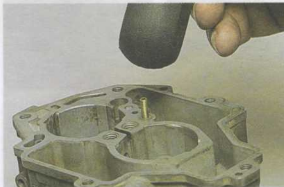
Трубку запрессовываем в канал корпуса карбюратора, слегка постукивая по ней пластмассовой ручкой отвертки.
