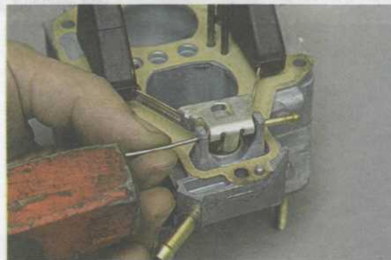
...выбиваем ось поплавков.
