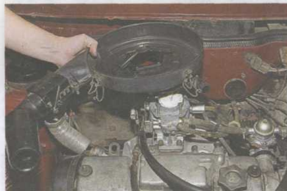
Снимаем со шпилек металлическую пластину.
