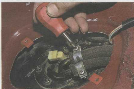
Отверткой ослабляем затяжку хомутов шлангов питающего и сливного топливопроводов.
