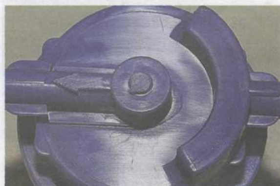
Устанавливаем новый фильтр так, чтобы стрелка на корпусе указывала на топливный насос. Затягиваем хомуты.
