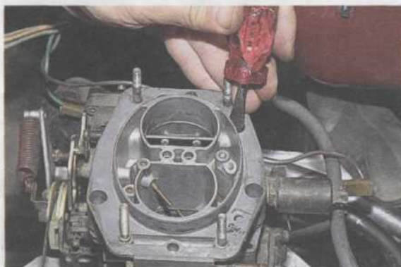
Отверткой отворачиваем пять винтов крепления крышки карбюратора.
