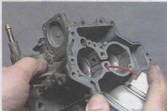
...его необходимо впрыснуть в каждый канал. Часто у карбюраторов, длительное время находящихся в эксплуатации, деформирован фланец. Для его проверки...
