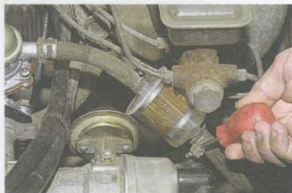
Отверткой ослабляем затяжку двух хомутов крепления резиновых шлангов.
