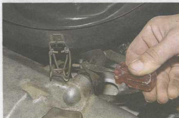
Ослабляем хомут шланга вентиляции картера.
