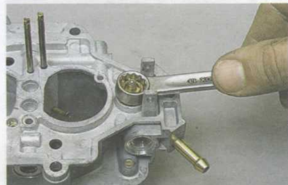
Ключом «на 11» отворачиваем топливный клапан.
