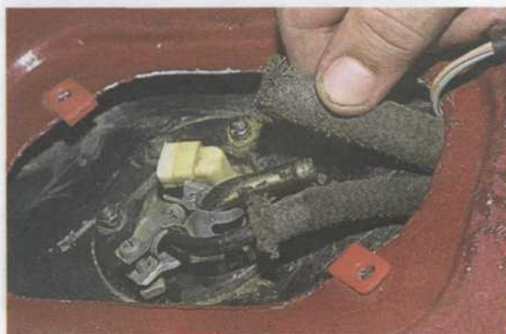
Снимаем шланги с патрубков топливозаборника.
