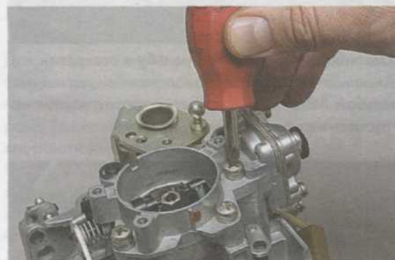
Крестообразной отверткой отворачиваем три винта крепления пускового устройства.
