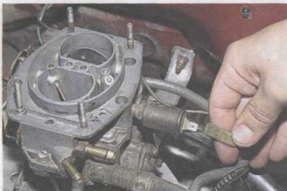
Снимаем наконечник провода с вывода электромагнитного клапана ЭПХХ.
