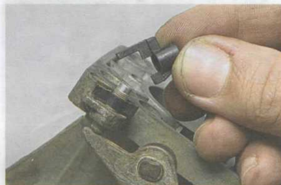
Снимаем защитный колпачок с упорного винта рычага заслонки второй камеры.
