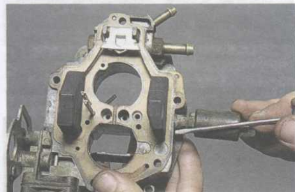
Отверткой отворачиваем пять винтов крепления крышки карбюратора.
