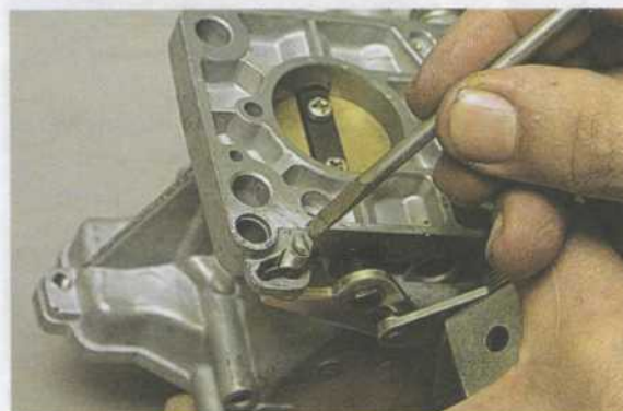
Винтом-упором регулируем положение дроссельной заслонки второй камеры. При просмотривании заслонки на свет, должен быть виден минимальный зазор по всему ее периметру.
