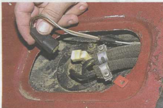
Отсоединяем колодку проводов от датчика указателя уровня топлива.
