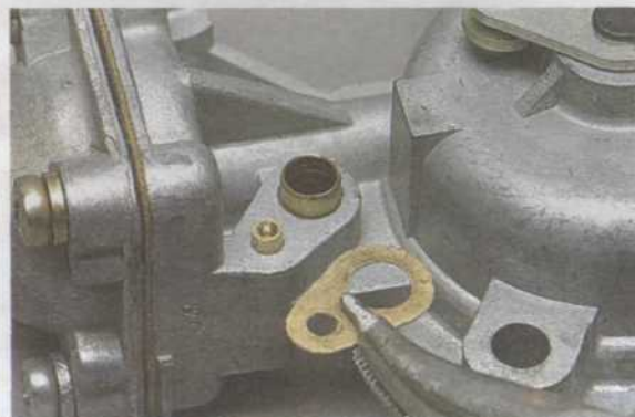
...поврежденную прокладку заменяем.
