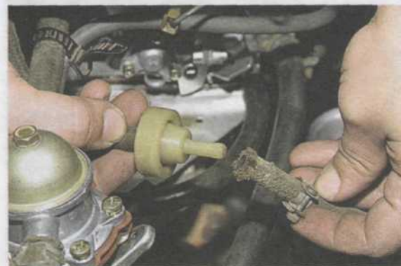
Снимаем шланги с патрубков клапана.
