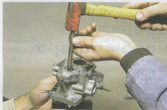
...и легкими ударами молотка через стержень заминаем концы резьбовой части.
