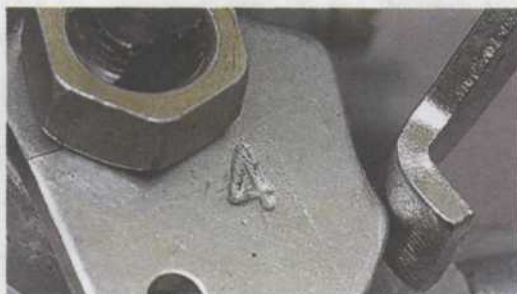
Пример маркировки кулачка привода ускорительного насоса
