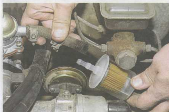
Снимаем шланги с патрубков фильтра и снимаем фильтр.
