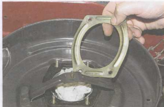
Снимаем со шпилек металлическую пластину.
