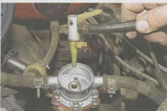
...продуваем сжатым воздухом внутреннюю полость насоса.
