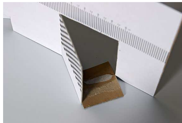
Шкала с мишенью для тестирования автофокуса ( скачать , 33 КБ)
