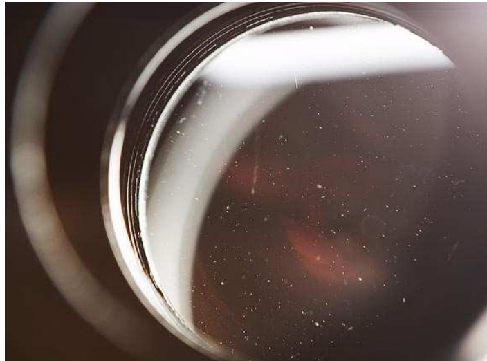
Оцениваем количество внутренней пыли и наличие пузырьков в линзах
