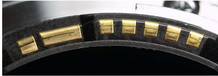
б) объективу более 2-х лет — на клеммах сформировалась четкая дорожка
