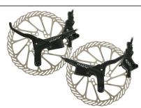
Farbe: schwarz Rotor: 185/185 Bremszange: 1 Kolbenpaar, PM Bremsscheibe: 6-Loch , einteilig Bremsmedium: DOT 4 Bremsbelag: Organisch Griffweiteneinstellung: Ja Druckpunktverstellung: Nein
