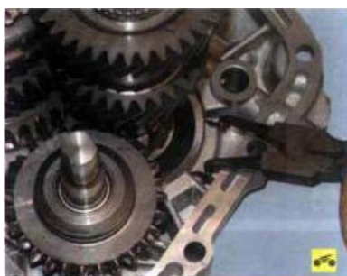
52. Вторым съемником для внешних стопорных колец (работающим на разжатие) разожмите стопорное кольцо первичного вала...
