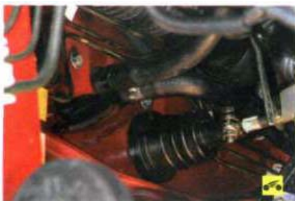
7. Осмотрите соединения шлангов системы охлаждения с патрубками радиатора отопителя...
