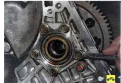
69. Выверните пять болтов крепления крышки правого подшипника дифференциала, снимите крышку, снимите с нее уплотнительное кольцо, затем выпрессуйте из крышки сальник и при необходимости наружное кольцо подшипника так же, как выпрессовывали их из регулировочной гайки.
