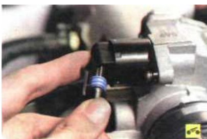
21. Ослабьте затяжку болта клеммного зажима привода управления механизмом переключения передач и разъедините тягу и наконечник рычага переключения передач.
