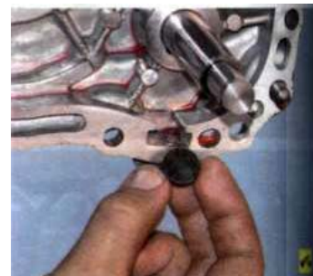
56. Съемником извлеките из проточки промежуточного картера стопорное кольцо подшипника первичного вала.
