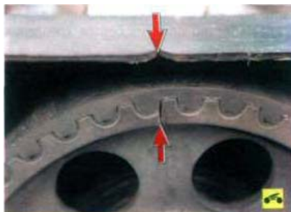
Рис. 5.3. Установочные метки на зубчатом шкиве распределительного вала и задней крышке ремня привода газораспределительного механизма: 1 - шкив распределительного вала; 2 - задняя крышка привода газораспределительного механизма; 3 - метка на задней крышке; 4 - метка на шкиве
