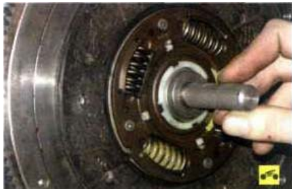
Рис. 6.2. Оправка для центрирования ведомого диска сцепления
