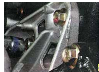
61. ...три болта крепления кронштейна к двигателю и снимите кронштейн.
