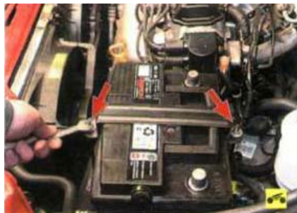
6. Ослабьте затяжку гаек крепления при- жимной планки.
