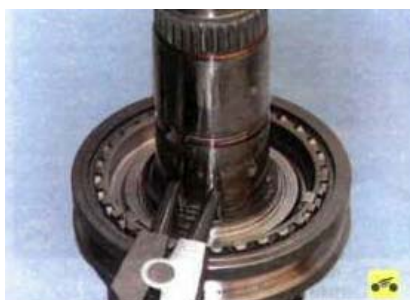
24. Разжав съемником стопорное кольцо ступицы синхронизатора III и IV передач...
