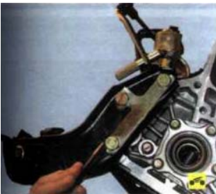
4. Зубилом отогните края стопорной пластины болтов крепления кронштейна задней опоры силового агрегата к картеру коробки передач.
