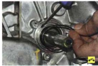
8. Снимите подшипник выключения сцепления (см. «Замена вилки и подшипника выключения сцепления», с. 136), направляющую втулку подшипника выключения сцепления (см. «Замена сальников коробки передач», с. 143) и установленное под втулкой резиновое уплотнительное кольцо.
