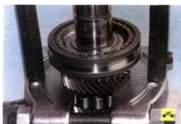
26. Спрессуйте со шлицев вала синхронизатор III и IV передач, прикладывая усилие к торцу ведомой шестерни IV передачи.
