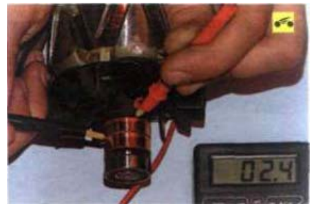
31. Проверьте тестером сопротивление обмотки ротора, подсоединив его к контактным кольцам. Сопротивление должно составлять примерно 2 Ом. Если тестер покажет бесконечность, значит, в обмотках обрыв и нужно заменить ротор.
