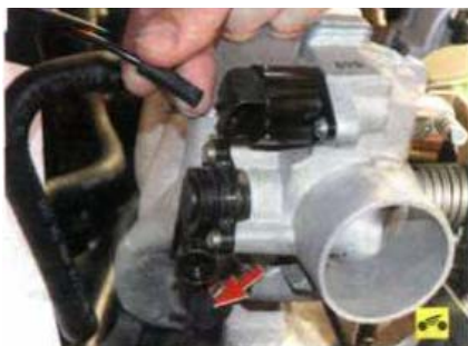
24. Отсоедините от патрубков дроссельного узла шланг к датчику абсолютного давления...
