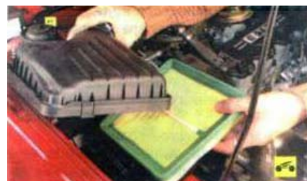
Фильтрующий элемент воздушно-го фильтра бумажный, плоский, с большой площадью фильтрующей поверхности.
