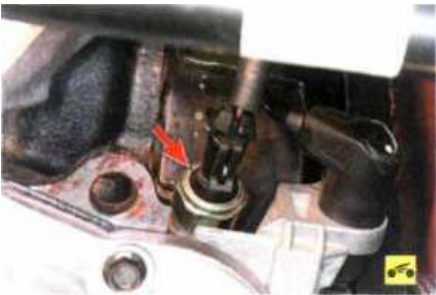
Датчик сигнальной лампы аварийного падения давления масла ввернут в корпус масляного насоса.
