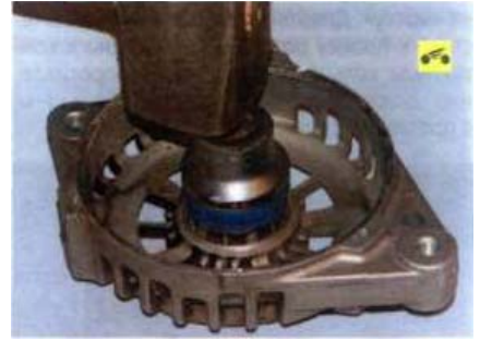
28. Запрессуйте новый подшипник в крышку оправкой подходящего диаметра, прикладывая усилие к наружному кольцу.
