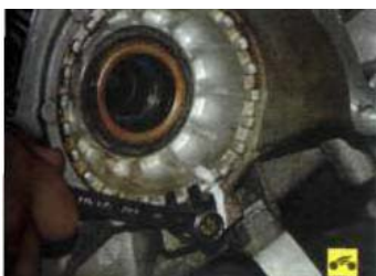
62. Выверните болт крепления фиксатора регулировочной гайки ...
