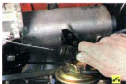
27. Отсоедините от сектора дроссельного узла наконечник троса привода дроссельной заслонки...
