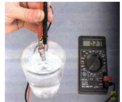
7. Для измерения сопротивления на выводах датчика при различных температурных режимах поместите датчик в горячую воду и проследите изменение его сопротивления по мере остывания воды: оно должно увеличиваться. Если датчик не реагирует на изменение температуры, то его необходимо заменить.
