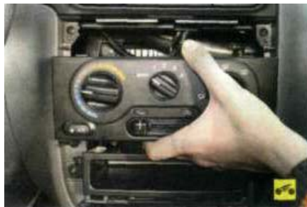
8. ...выведите три фиксатора в верхней части блока из зацепления с панелью приборов и переместите блок на себя настолько, насколько позволяет длина проводов и тяг.
