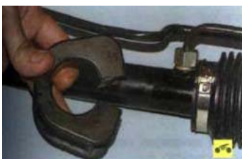
Рис. 8.4. Нейтральное положение рейки, соответствующее прямолинейному движению автомобиля: 1 - болты крепления рулевых тяг; 2 - правая рулевая тяга; 3 - кожух картера рулевого механизма; 4 - левая рулевая тяга; 5 - картер рулевого механизма; 6 - левая опора
