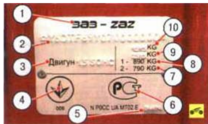
Рис. 1.5. Идентификационная табличка: 1 - завод-изготовитель; 2 - идентификационный номер автомобиля; 3 - объем и тип двигателя; 4 - национальный знак соответствия ДСТУ 2296; 5 - номер одобрения типа транспортного средства России, 6 - знак соответствия сертификации; 7 - допустимая нагрузка на заднюю ось автомобиля; 8 - допустимая нагрузка на переднюю ось автомобиля; 9 - полная допустимая масса автомобиля с прицепом; 10 - допустимая полная масса автомобиля.
