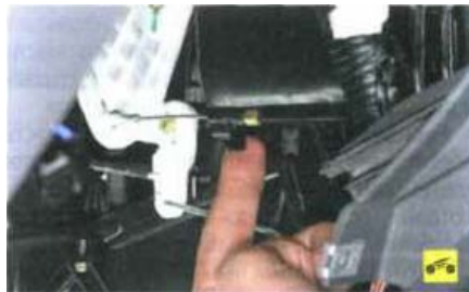
10. Отжав пальцем фиксатор оболочки тяги управления заслонкой распределения потоков воздуха...
