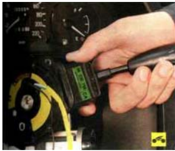
4. Выверните четыре винта крепления...
