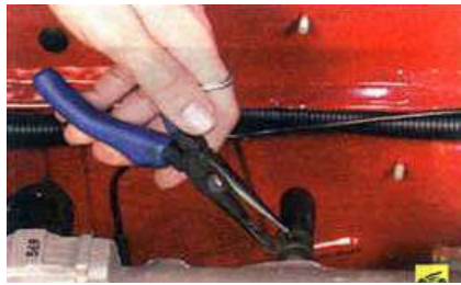
53. Ослабьте хомут крепления шланга вакуумного усилителя тормозов, сжав пассатижами его отогнутые ушки, сдвиньте хомут по шлангу...
