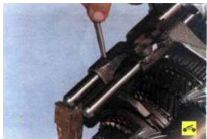
47. Выберите штифт крепления вилки переключения III и IV передач...
