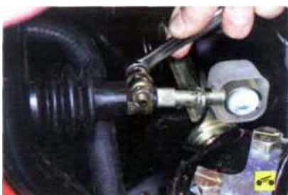
21. Ослабьте затяжку болта клеммного зажима привода управления механизмом переключения передач и разъедините тягу и наконечник рычага переключения передач.
