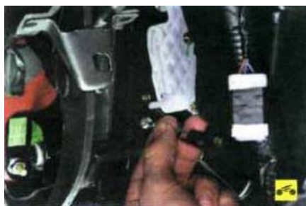
11. ...отсоедините оболочку от корпуса отопителя и снимите тягу с пальца рычага заслонки.
