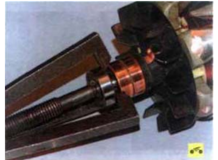
30. ...спрессуйте подшипник съемником с вала ротора и установите новый, прикладывая усилие к внутреннему кольцу.
