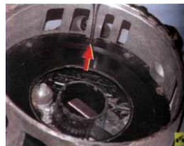
15. Для снятия выпрямительного блока и регулятора напряжения снимите защитный кожух. Для этого протолкните два фиксатора внутрь крышки ...
