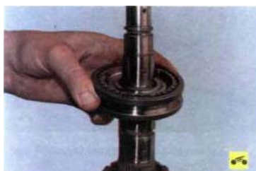
26. Спрессуйте со шлицев вала синхронизатор III и IV передач, прикладывая усилие к торцу ведомой шестерни IV передачи.
