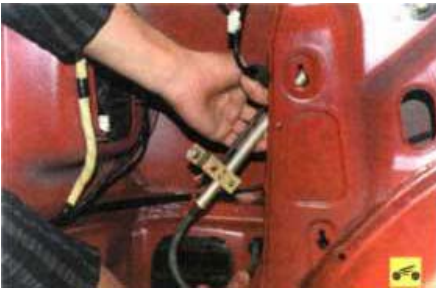
7...и снимите антенну, вытащив дренажный шланг из уплотнителя в отверстии кузова.
