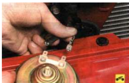
Рис. 10.7. Номера выводов дополнительной колодки переключателя указателей поворота и света фар.
