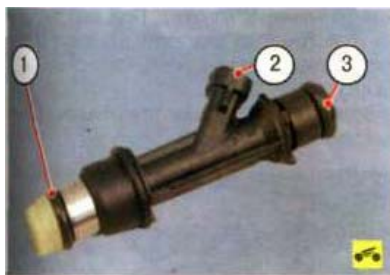
Рис. 5.23. Форсунка системы впрыска топлива: 1 - нижнее уплотнительное кольцо; 2 - штекерные выводы обмотки электромагнита; 3 - верхнее уплотнительное кольцо
