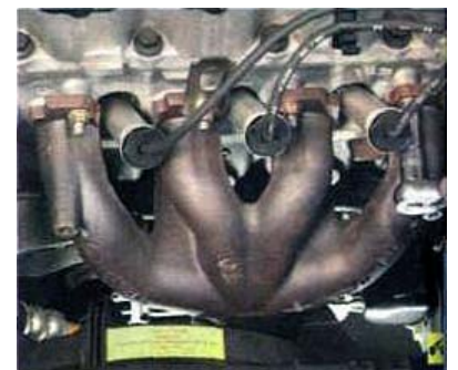
Рис. 5.6. Последовательность отворачивайте крепления выпускного коллектора
