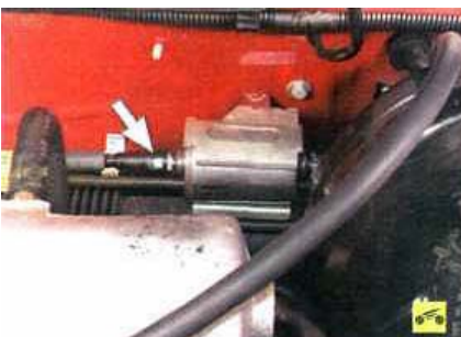
52. , ... от топливного фильтра отводящий шланг, сжав фиксаторы запорных элементов наконечников шлангов.
