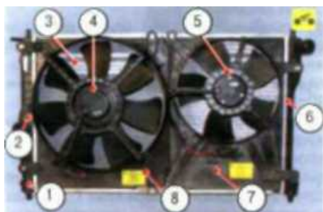
Рис. 5.16. Радиатор и электровентиляторы системы охлаждения: 1 - сливной кран; 2 - отводящий бачок; 3 - сердцевина; 4 - основной электровентилятор; 5 - дополнительный электровентилятор; 6 - отводящий бачок; 7 - кожух дополнительного электровентилятора; 8 - кожух основного электровентилятора
