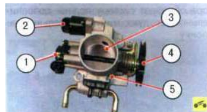
Рис. 5.24. Дроссельный узел: 1 - датчик положения дроссельной заслонки; 2 - регулятор холостого хода; 3 - дроссельная заслонка; 4 - сектор привода дроссельной заслонки; 5 - корпус дроссельного узла
