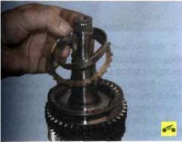
9. ...промежуточное кольцо и наружное блокирующее кольцо синхронизатора I передачи.
