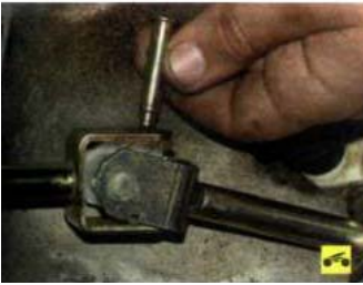
3. ...и извлеките ось шарнира привода переключения передач. Разъедините вилки шарнира.
