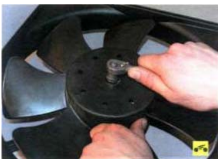
5. Отверните гайку крепления крыльчатки к валу электродвигателя...
