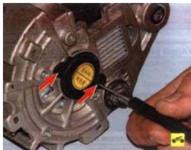
7. Аналогично протолкните внутрь два фиксатора защитной крышки заднего подшипника генератора...
