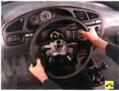
2. Снимите рулевое колесо (см. «Снятие и установка рулевого колеса», с. 176), предварительно установив его в положение, соответствующее прямолинейному движению.
