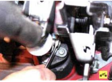
4. Под панелью приборов отверните гайку и извлеките болт клеммового соединения рулевого вала и эластичной муфты.
