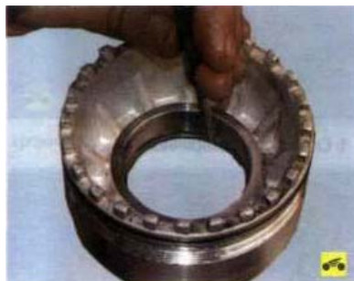
67. При необходимости замены подшипников дифференциала переверните регулировочную гайку, подложите пару деревянных брусков и выпрессуйте из гайки наружное кольцо подшипника дифференциала.
