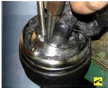
7. ...разожмите стопорное кольцо съемником стопорных колец и сбейте обойму с вала молотком через бородок.
