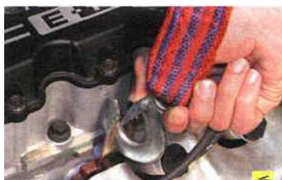
56. ...затем два верхних болта и отведите компрессор в сторону, не отсоединяя от него трубопроводы.
