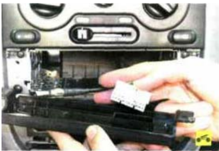
5. ...отведите заглушку от панели приборов, отсоедините от заглушки колодку жгута проводов, выньте из держателя кабель антенны и снимите заглушку.
