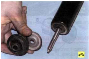
10. Снимите со штока амортизатора нижнюю резиновую подушку в сборе с распорной втулкой и шайбу.
