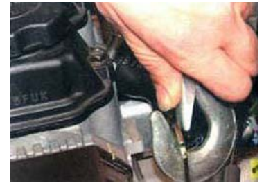
58. ...и заднюю транспортные проушины, натяните стропы, чтобы разгрузить опоры силового агрегата ...
