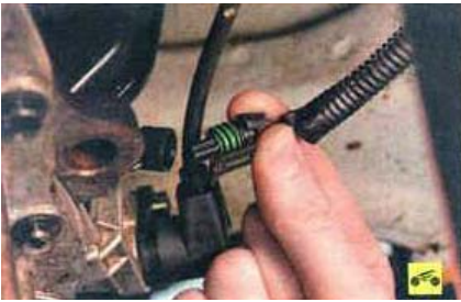
49. Отсоедините колодку жгута проводов от датчика сигнальной лампы аварийного падения давления масла.
