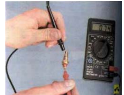
6. Для проверки подсоедините тестер в режиме омметра к выводу и корпусу датчика. Сопротивление датчика при комнатной температуре должно составлять 0,7-0,8 кОм.
