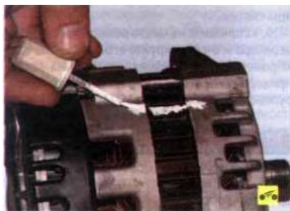
4. Пометьте взаимное расположение статора и крышек генератора.
