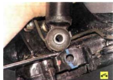
12. Установите амортизатор вертикально и несколько раз до упора опустите и поднимите шток амортизатора. Убедитесь в том, что шток перемещается без провалов, заеданий и стуков. В противном случае замените амортизатор. Кроме того, замените амортизатор при обнаружении потеков жидкости (допускается незначительное отпотевание в верхней части корпуса) и при повреждении резьбы в верхней части штока.
