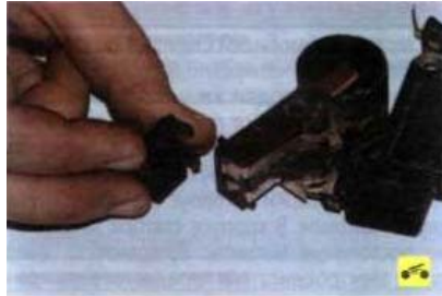
23. Снимите крышку щеткодержателя, отжав три фиксатора ее крепления.
