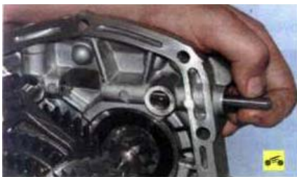
46. Из отверстий промежуточного картера извлеките штифт блокировки одновременного включения двух передач.
