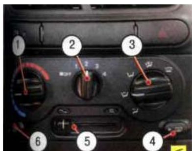
Рис.11.3. Панель управления отоплением и кондиционированием: 1- регулятор температуры поступающего в салон воздуха; 2 - переключатель режимов работы вентилятора воздуханогнетателя; 3 - регулятор распределения потоков воздуха; 4 - выключатель электрообогрева стекла окна задка; 5 - переключатель режима рециркуляции; 6 - выключатель кондиционера.
