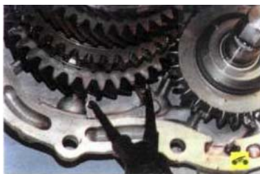
51. Съемником для внутренних стопорных колец (работающим на сжатие) сожмите пружинное стопорное кольцо вторичного вала и зафиксируйте в таком положении.
