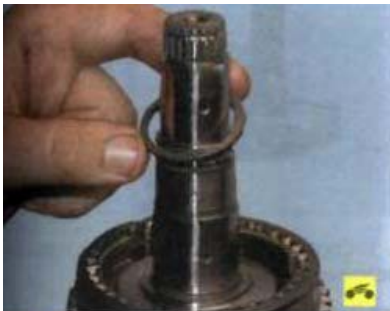
10. Разжав съемником и поддев отверткой, снимите стопорное кольцо...
