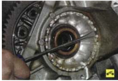
64. ...и, подсчитывая число оборотов, выверните регулировочную гайку отверткой, как показано на фото.
