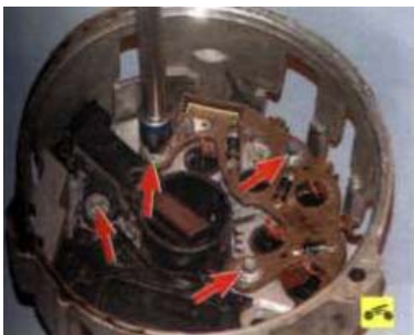
19. Выверните четыре болта крепления выпрямительного блока и регулятора напряжения ...
