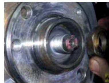
Рис. 7.4. Подшипник передней ступицы: 1,2 - стопорные кольца; 3 - подшипник; 4 - кулак амортизаторной стойки; 5 - ступица
