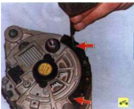
5. Протолкните бордочком внутрь крышки генератора два фиксатора...
