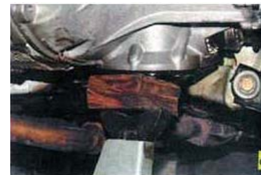
59. ...и установите для страховки надежную опору под картер коробки передач.
