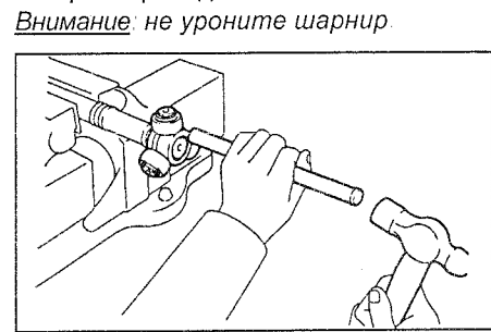
в) С помощью медного стержня и молотка напрессуйте тройной шарнир на приводной вал.
