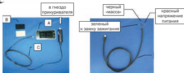
Рис. 3. Подсоединение дисплея к источнику питания.
