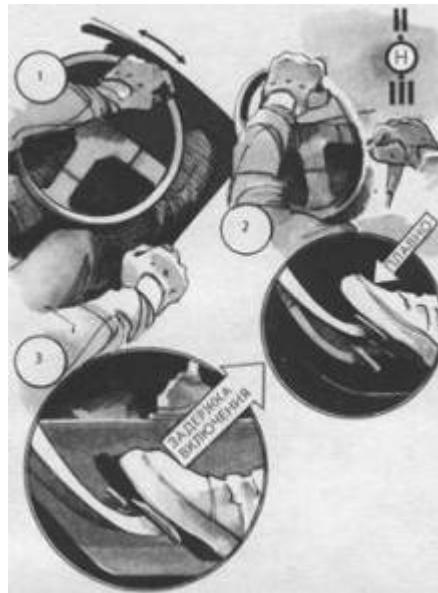
*Приемы безопасности на очень скользкой дороге: задержка включения сцепления ("мягкое включение"); "перегазовка", исключающая пробуксовку и блокирование; опережающая коррекция рулевым колесом, устраняющая рыскания автомобиля.*
