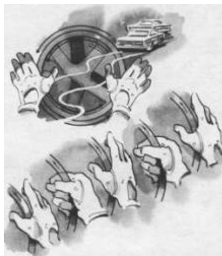
*Сохраняйте плотный постоянный контакт с рулевым колесом при любых маневрах, поворачивая его и выравнивая. Распускание рулевого колеса на выходе из поворота может привести к потере устойчивости автомобиля*
