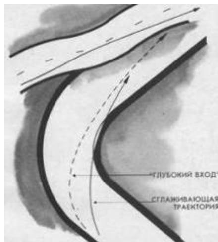
*Чтобы уменьшить действие центробежной силы в повороте и повысить собственную безопасность, постарайтесь максимально увеличить радиус дуги. Для этого перед входом в поворот сместите автомобиль к наружной стороне, в самой крутой части дуги переместитесь внутрь, а на выходе опять вернитесь на внешнюю сторону дороги.*
