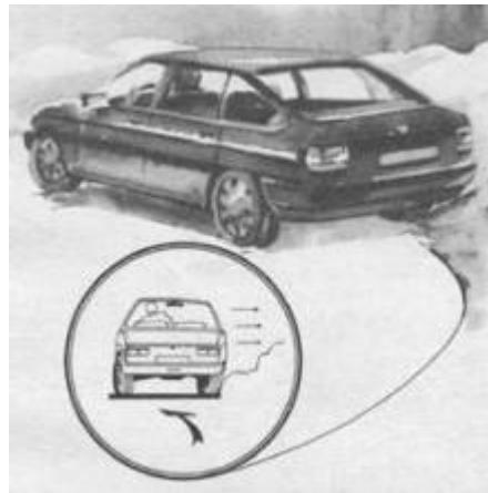
*Скользящему и рыскающему на скользкой дороге автомобилю можно придать дополнительную устойчивость, используя опыт трамвайной езды. Внутренней частью колеса можно “зацепиться” за продольные неровности, снежный бортик или участок дороги с высоким коэффициентом сцепления.*
