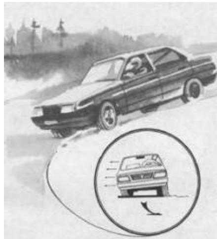
*Обопритесь наружной частью колеса о снежный вал в повороте и вы сможете успешно противодействовать центробежной силе. “Упор” поможет избежать сноса и заноса автомобиля, сохранить устойчивость и управляемость. Желательно, чтобы “упор” происходил “тянущим” колесом (передним – для переднеприводного автомобиля и задним – для заднеприводного).*
