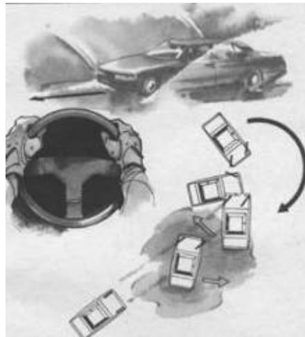
*Преодолевая лужу на большой скорости, стремитесь: двигаться по прямой, исключая любые маневры; силовым симметричным хватом рулевого колеса в верхнем секторе зафиксировать его в неподвижном положении; приготовьтесь к реакции на занос, при выходе передних колес на твердый грунт.*
