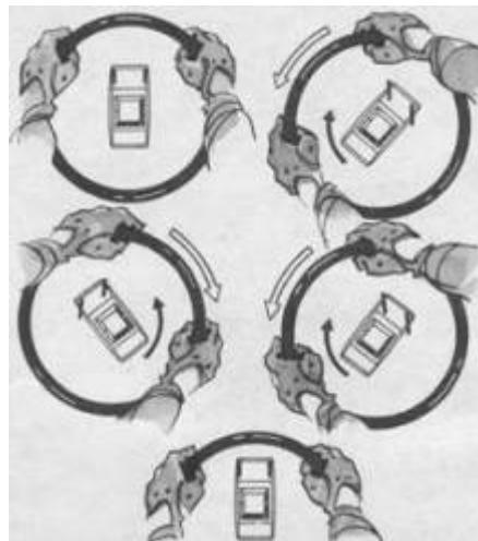
*Преодолеть серию импульсов ритмического заноса можно серией противонаправленных рывков рулевого колеса без смены или со сменой хвата рук при больших углах заноса. Желательно избегать задержек при сменах направления руления и каждым последующим импульсом стремиться опередить развитие заноса.*
