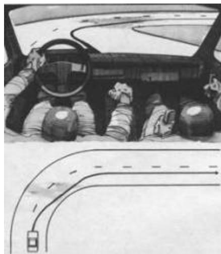
*Двойной вход поможет вам преодолеть бугор, яму или глубокую лужу в середине поворота. Разорвите длинную дугу на два отдельных поворота и переходную кривую и вы уменьшите риск потери управляемости.*
