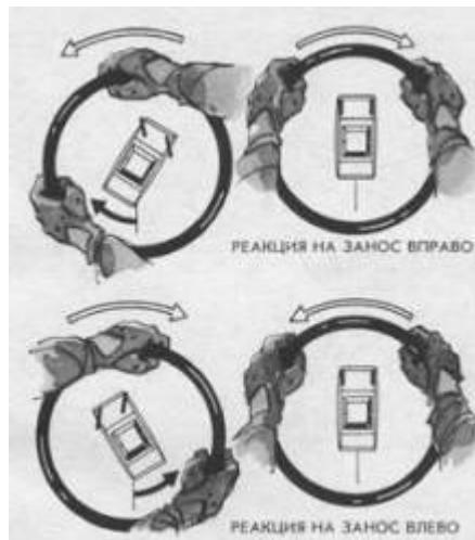
*Не ждите усиления заноса, реагируйте сразу резким рывком обеих рук в сторону заноса. Одновременно с поворотом рулевого колеса “прикройте газ”. Если вы тотчас мягким движением не выровняете колеса, может возникнуть ритмический занос, направленный в противоположенную сторону.*
