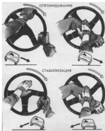
*Страхуясь от опрокидывания, прекратите торможение, с силой поверните рулевое колесо в сторону опрокидывания, а затем выровняйте автомобиль.*
