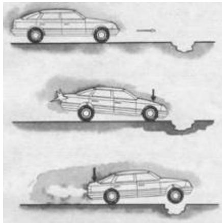
*Глубокую яму и другие неровности вы сможете преодолеть без повреждения дисков колес, если примените прием “загрузка – разгрузка”. Перед препятствием резко нажмите и отпустите тормозную педаль. Воспользуйтесь реакцией передней подвески вверх после “клевка” автомобиля и вы существенно смягчите силу удара. Можно усилить действие приема, если вы сумеете выполнить торможение левой ногой, не прекращая дросселирование правой.*
