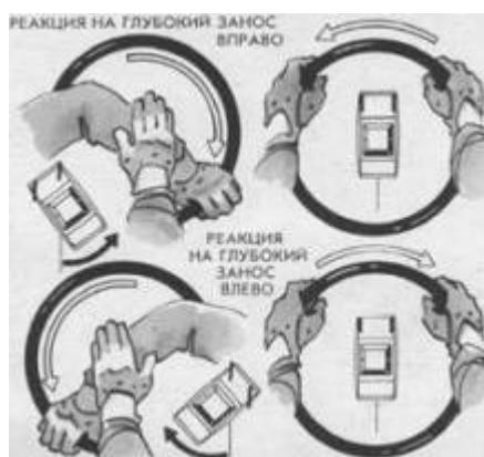
*Если вам не удалось стабилизировать автомобиль на ранней стадии заноса, то после рывка двумя руками выполните “доворот” одной из рук, которая окажется в верхнем секторе рулевого колеса; одновременно “прикройте газ”. Лучше выполнять “доворот” левой рукой, чтобы освободить правую для экстренного включения понижающей передачи. Этот прием поможет повысить тягу двигателя, чтобы преодолеть центробежную силу, выбрасывающую автомобиль с дороги*
