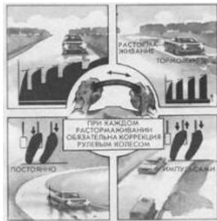
*Выбирайте способ торможения в зависимости от дорожных условий. Применяйте торможение с постоянным усилием только на повороте или неровностях. Начинайте торможение коротким импульсом, а затем увеличивайте тормозные усилия. Рыскающий автомобиль стабилизируйте рулением в каждый период растормаживания. Усиливайте антиблокировочный эффект включением пониживающих передач. Не блокируйте колес!*
