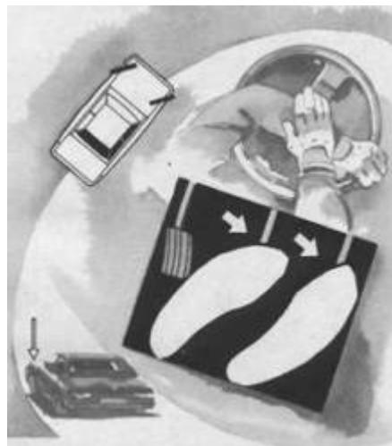
*Повысить управляемость в крутом повороте вам поможет загрузка наружного переднего колеса при помощи торможения двигателем или легкого подтормаживания левой ногой. Помните, что полное прекращение тяги (“закрытый газ”) не повысит, а снизит безопасность.*
