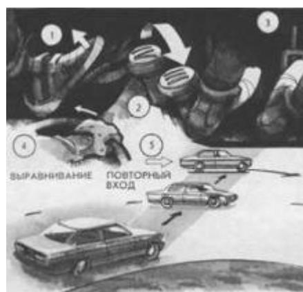
*Чтобы вернуть автомобилю управляемость, потерянную при сносе передних колес в повороте: выполните повторный вход (вначале выровняйте колеса, а затем вновь поверните их); загрузите наружное переднее колесо любым доступным вам способом (торможением двигателем, легким подтормаживанием левой ногой, включением понижающей передачи). Преодолейте страх и откажитесь от резкого торможения.*
