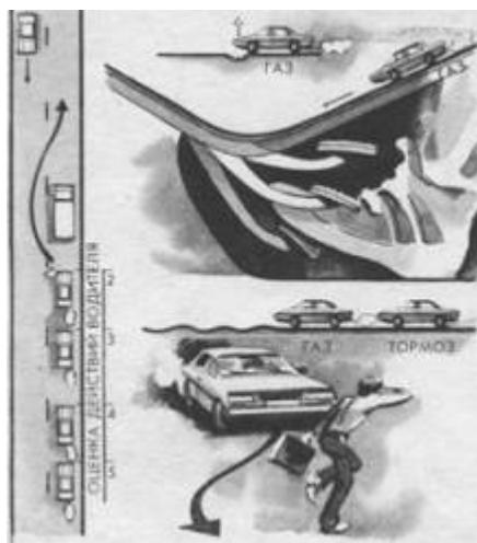
*Чем выше частота вращения коленчатого вала двигателя, тем большей динамикой обладает автомобиль. При малой частоте вращения он очень поздно реагирует на педаль подачи топлива. Поэтому начинайте подготовку к маневру с увеличения частоты. Раннее дросселирование и хорошая тяга двигателя позволят вам сократить время маневра и степень опасности.*
