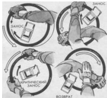
*Преодолеть критический занос можно тремя путями: выровнять автомобиля за счет сверхскоростного руления на пределе возможностей подготовленного водителя; развернуть автомобиль на 360° относительно прямого направления, используя для этого серию приемов высшего мастерства (см. прием 40); использовать сильный тормозной эффект для снижения скорости, сохраняя угол заноса корректирующим рулением и переменным дросселированием.*
