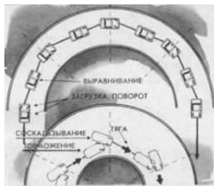
*Чтобы застраховаться от неожиданного сноса передних колес в длинном скоростном повороте, раздробите дугу на короткие отрезки и микроповороты. Вы получите возможность одну большую опасность разделить на серию мелких, каждую из которых легче преодолеть*
