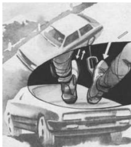
*Прием “газ-тормоз” поможет вам создать антиблокировочный эффект на ведущих колесах. При интенсивном торможении на переднеприводном автомобиле этот прием*
