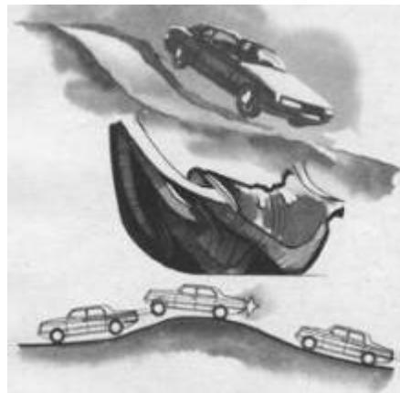
*Перед подбросом, подскоком, прыжком поставьте левую стопу на тормозную педаль, а в момент отрыва передних колес от грунта коротким тормозным импульсом прижмите передние колеса к дороге. Это позволит вам избежать потери управляемости автомобиля и сохранить целостность передней подвески и картера двигателя.*
