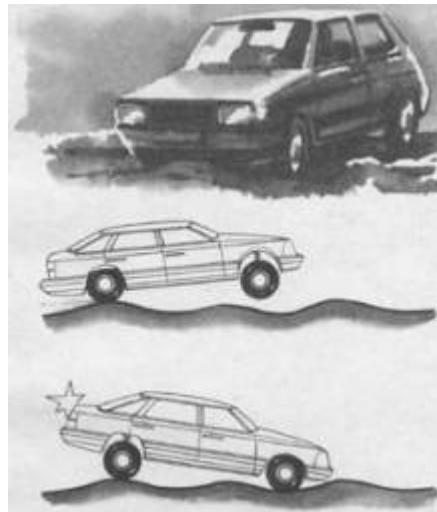
*Резонанс раскачивания передней подвески на небольших неровностях можно погасить резкими бессистемными импульсами дросселирования или несколькими короткими тормозными усилиями левой ноги при открытом дросселе.*
