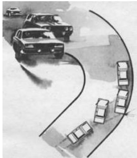
*Если автомобиль выносит наружу на обледенелом повороте, используйте снежное препятствие как опору для торможения и возврата управляемости.*
