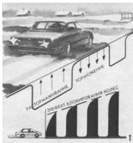
*На участках с меняющимся коэффициентом сцепления или неровностях применяйте только импульсное (прерывистое) торможение. Тормозное усилие и продолжительность торможения выбирайте в зависимости от ровности и зацепления покрытия под передними колесами. Тотчас ослабляйте или прекращайте торможение при возникновении блокирования колес. Увеличивайте давление на педаль при каждом последующем усилии.*
