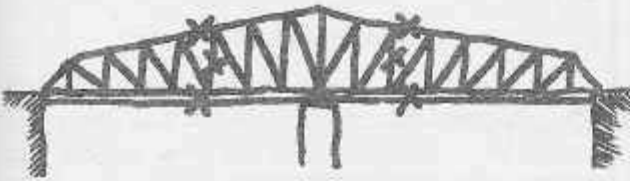
Рисунок 87. Мост со сквозными фермами.
