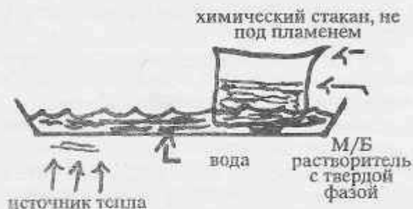
Рисунок 8. Нагревание раствора ДМТ на водяной бане
