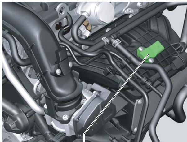
Датчик давления во впускном коллекторе G71 с датчиком температуры воздуха на впуске G42 S405_044
