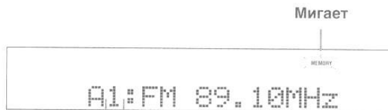
Номер предустановленной радиостанции
