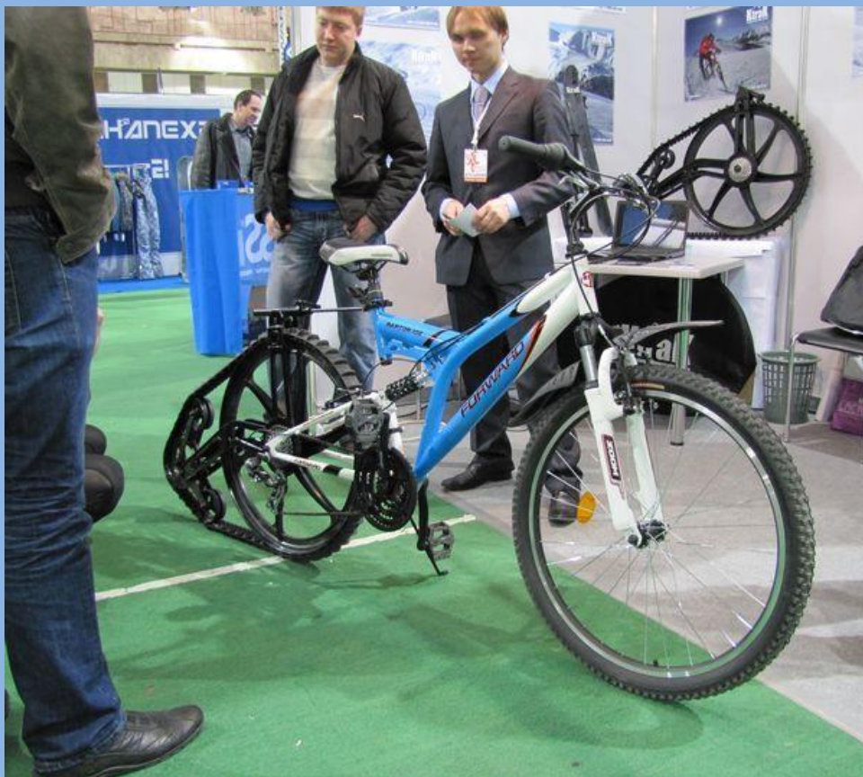
Вероятно, как наш ответ на "Московский снегармагедон 2.0" ашан-подвес Forward изувечили пристяжным гусеничным трактом, который делает байк условно годным для езды по снегу и льду, но при этом напрочь лишает какой-либо динамики.
